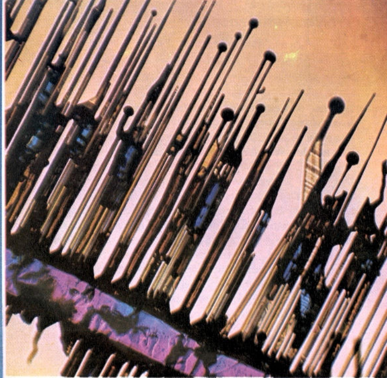
Oben: Im Labor gezüchtete Saphirfasern (blaues Aluminiumoxid) sind fast perfekte Kristalle, die starken Beanspruchungen standhalten.
