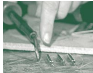
Die Metallspitzen des LötKolbens entscheiden über die Strichstärke.
