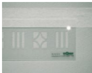
Der Laserpunkt ermöglicht eine genaue Positionierung, z.B. von Schablonen.
