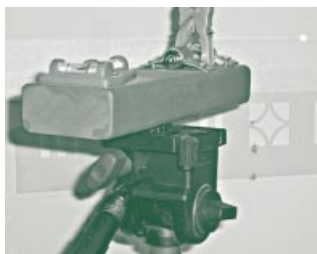
Die Kreuzwasserwaage (links) sorgt für einen absolut ebenen Stand. Das Fotostativ kann horizontal und vertikal geschwenkt werden.
