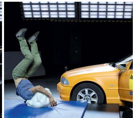
Rundum geschützt. Beim Aufprall auf dem Boden ist der Kopf von allen Seiten durch den Airbag abgesichert.
