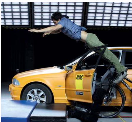
Crashtest. Ein Stuntman mit einem Hövding um den Hals stürzt für uns vom Fahrrad über eine geöffnete Autotür.
