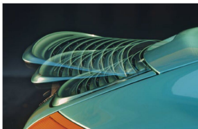
Neu: konventioneller Drehschalter. Alt: Zündschloss links vom Lenkrad. Scheinwerfer- Reinigungsanlage für 400 Mark Aufpreis (1997). Typisch 911: Über Tempo 80 fährt automatisch der Heckspoiler aus
