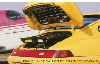
Doppelte Kühlung: zwei Ladeluftkühler unter der Motorhaube
