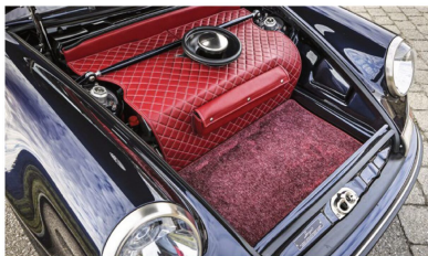
Das ochenblutrote Leder kleidet auch den Kofferraum aus. In der Mitte sitzt der Tankstutzen. Gut zu erkennen: die Einstellschrauben der vorderen Federbeine sowie die Domstrebe
