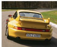
Einstellbar: Heckflügel und Stabilisator des Turbo GT
