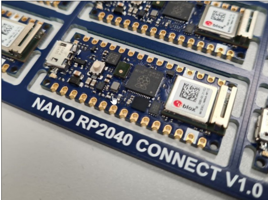
Abb. 9.4: Arduino Nano RP2040 Connect (Quelle @arduino bei Twitter)
