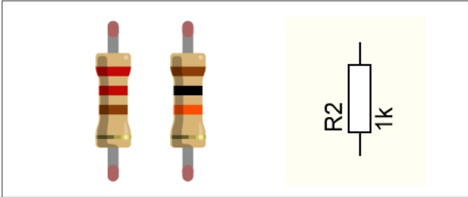
Abb. 3.12: Widerstand: Bauteil (links) und Schaltzeichen (rechts)
