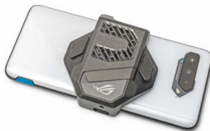
Der ansteckbare Lüfter des Asus Rog Phone 5 erweitert es um zwei zusätzliche Tasten und einen ausklappbaren Ständer.
