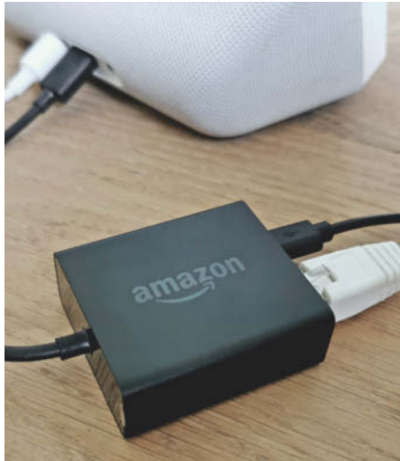
Amazons Echo Show 5 kann man mit einem aktiven Adapter per Ethernet ins Netz hängen.
