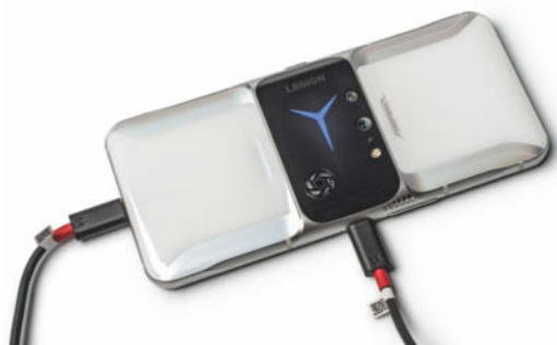
Kurios: Das Lenovo entfaltet seine volle Ladegeschwindigkeit nur, wenn zwei Ladekabel gleichzeitig eingesteckt sind.
