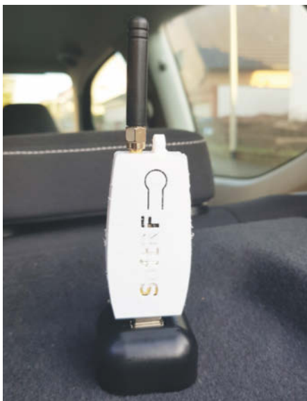
Ein USB-Standfuß setzt den T-Motion-Stick im Auto vom Kfz-USB-Adapter ab, sodass dieser auf Fensterhöhe positioniert werden kann und nicht hinter der stark abschirmenden Blechkarosserie sitzt.
