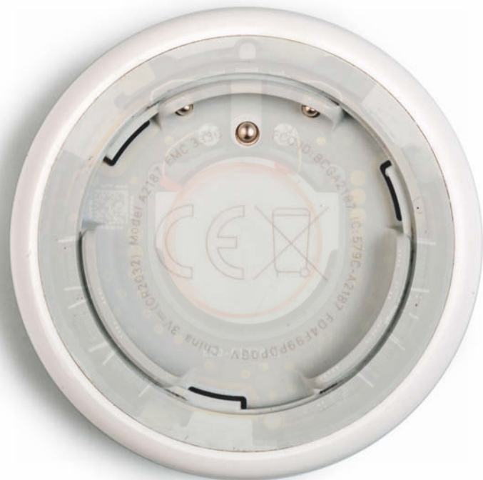
Die Lautsprecherspule in der Mitte ist auf der Oberseite der Platine verlötet und lässt sich daher leicht anbohren. Damit verstummt das AirTag für immer, ohne seine Ortungsfunktion einzubüßen.
