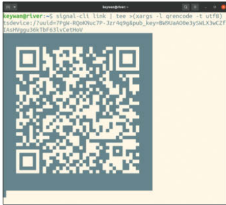
Aus der Ausgabe von signal-cli erzeugt qrencode den QR-Code, den die Signal-App zum Koppeln benötigt.
