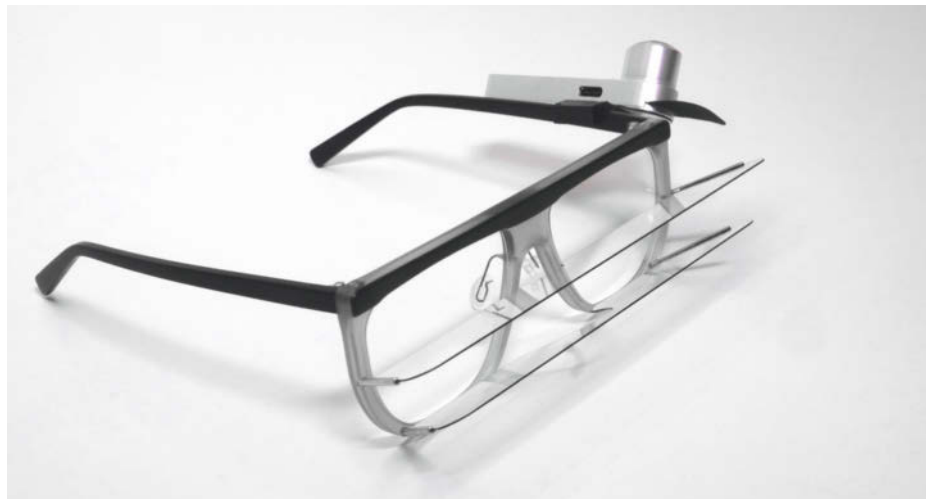
Der aktuelle Prototyp der etwa 70 Gramm leichten Gixel-Brille: Am Bügel ist die Hardware für das Tracking-System befestigt.
