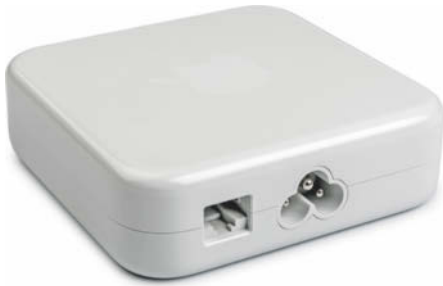
Apple hat beim neuen iMac den LAN-Anschluss ins Netzteil ausgelagert.
