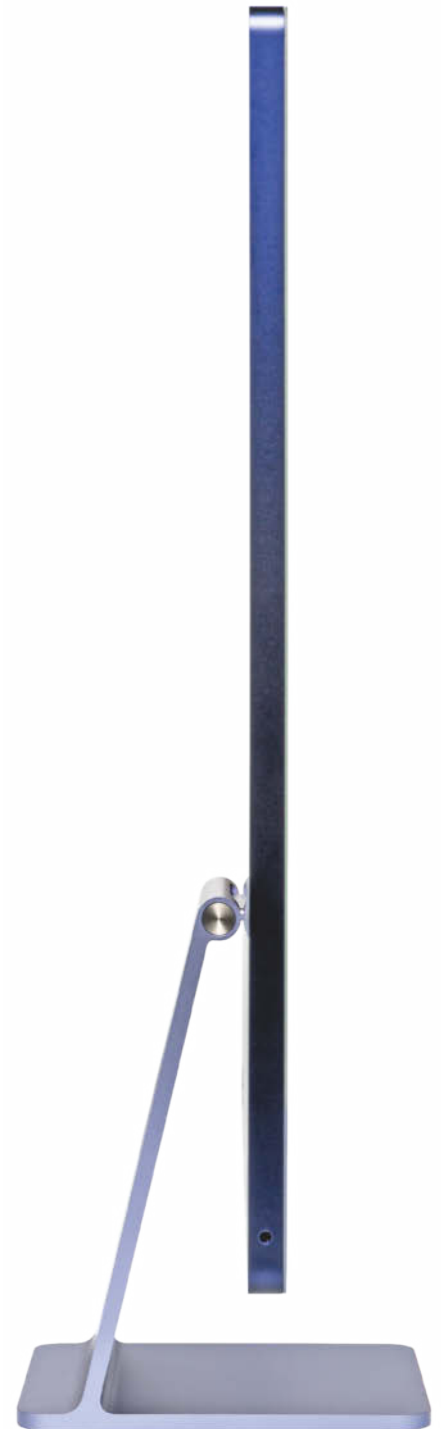
Das Gehäuse des neuen iMac ist nur knapp 12 Millimeter dünn. Der Winkel lässt sich über den Standfuß verstellen, die Höhe hingegen nicht.
