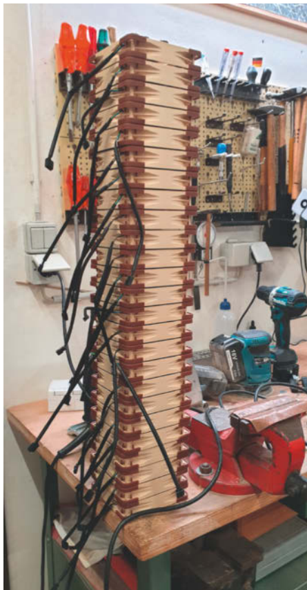
Statt eines lauten Radiallüfters drücken 25 leise PC-Ventilatoren die Raumluft durch die Filter.
