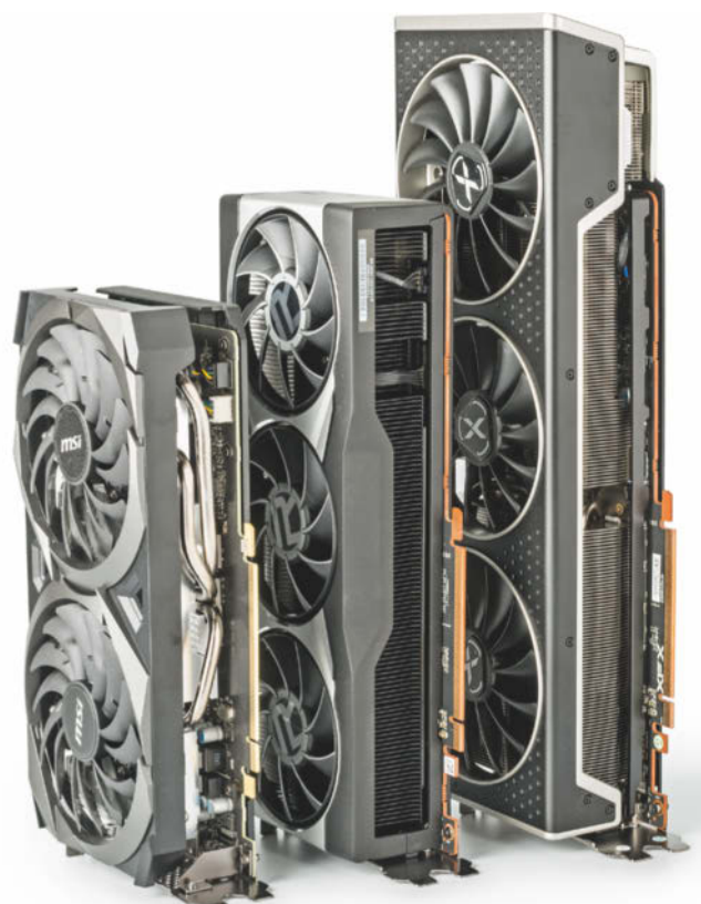
Gegenüber der 34 Zentimeter langen XFX Merc 319 (rechts) wirken selbst andere High-End-Karten wie die Radeon RX 6800 XT (Mitte) oder MSIs RTX 3070 Ventus 2X OC (links) geradezu winzig.
