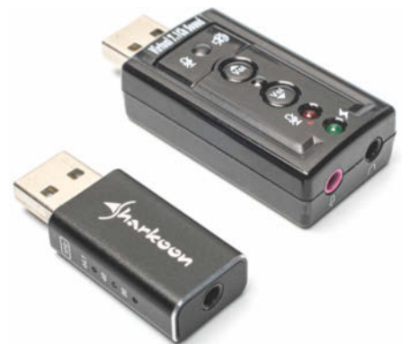
Der Audioadapter Gaming DAC Pro S V2 von Sharkoon (links) bereitet Audio- und Mikrofonsignale für Kopfhörer mit TRRS-Klinke auf. Die CSL-Soundkarte rechts oben im Bild separiert Kopfhörer und Mikrofon, sodass man Headsets mit zwei Klinkensteckern ans TV schließen kann.
