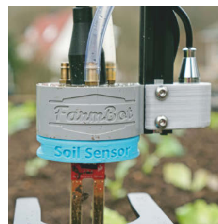
Am „Universal Tool Mount“ (UTM) docken beim FarmBot Genesis magnetisch verschiedene Werkzeuge an, die der Roboter selbst wechseln kann. Rechts vom UTM hängt die Kamera.
