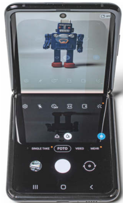
Im Z Flip nutzt Samsung ultradünnes Glas als Deckschicht, die Touchschicht wurde ins Panel integriert.
