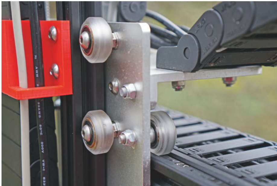
Beim FarmBot Genesis fahren alle Achsen mit kugellagerten Rollen in v-förmigen Nuten der Aluprofile. Den Rollenabstand sollten sie mit den Exzentermuttern so einstellen, dass alle Achsen sich sehr leicht bewegen lassen.
