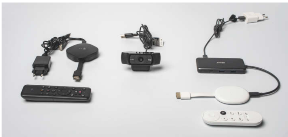
Der HDMI-Stick der Telekom (links) hat schon von Haus aus eine USB-A-Buchse zum Anschließen von Zubehör. Beim Chromecast mit Google TV (rechts) benötigt man einen aktiven USB-C-Hub, um die Webcam zu verbinden.
