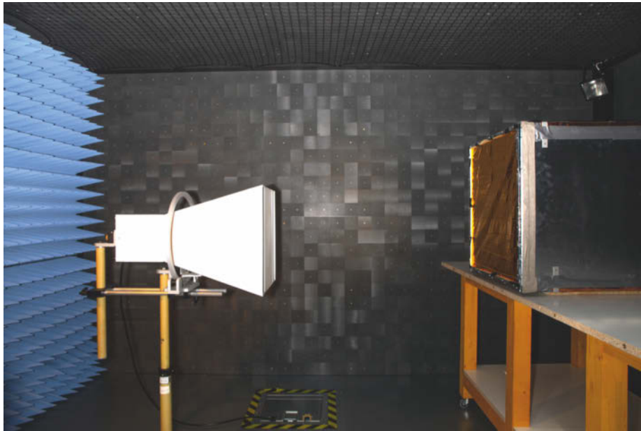
Zwei Sender im Schirmwürfel (rechts) liefern ein Signal, das eine Hornantenne auffängt. Der Pegelunterschied mit und ohne Materialprobe, hier eine Rettungsdecke, ergibt das Dämpfungsmaß.
