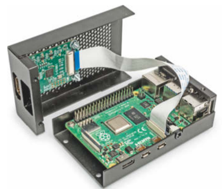
Das Aluminiumgehäuse von GeekPi besteht aus vier Teilen, die sich für den Einbau des HDMI-CSI-Adapters leicht bearbeiten lassen.
