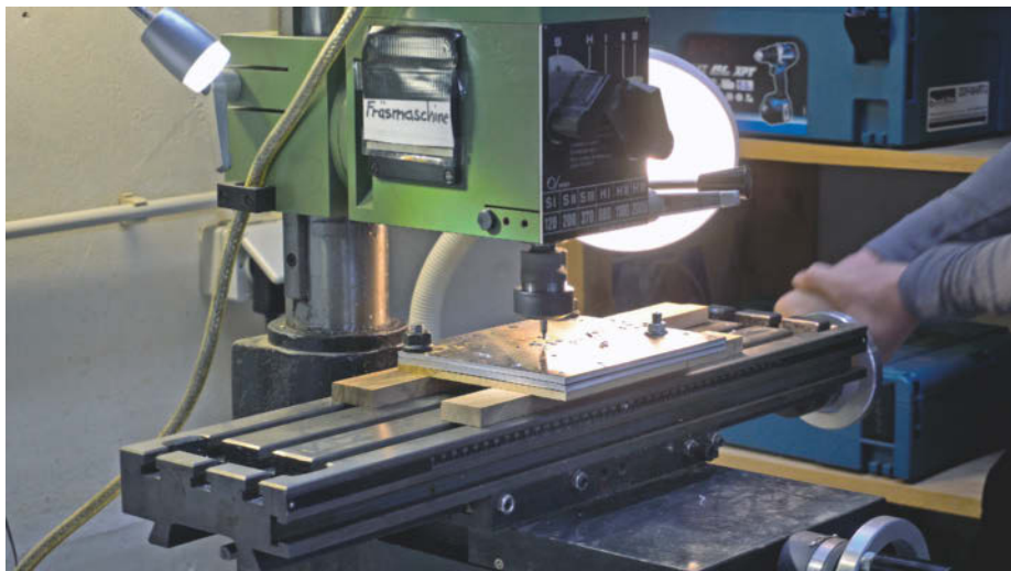
Wer die Aluplatten selbst fertigt, sollte darauf achten, dass die Schraubenlöcher für die Rollen exakt fluchten. Ein Kreuzzisch hilft, hier exakt zu arbeiten.
