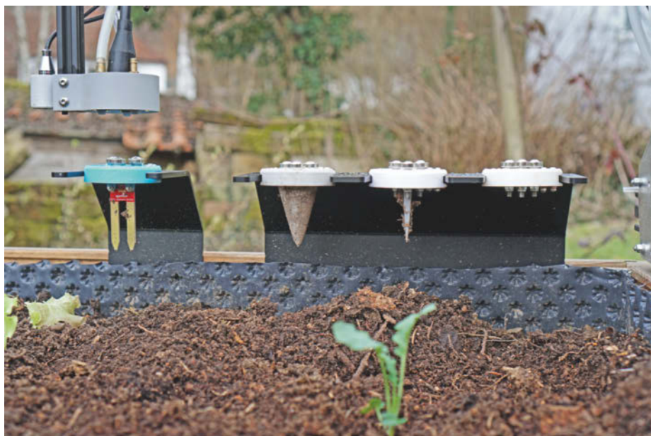
Die wechselbaren Werkzeuge in den „Toolbays“: Bodenfeuchtesensor, Pflanz-Spitze, Jätwerkzeug, Gießkopf. An den Bodenfeuchtesensor dockt gerade das „Universal Tool Mount“ (UTM) an.
