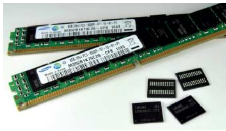
Die SDRAM-Bauelemente dieser kompakten 8-GByte-RDIMMs enthalten Chip-Stacks.
