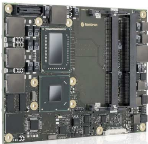
COM-Express-Platinen beherbergen Prozessor, Chipsatz und Speicher. Alles andere übernimmt ein Basisboard. So kann man relativ leicht aufrüsten.
