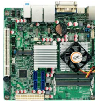
Das Jetway NC85-E350-LF besitzt bloß einen PCI-Slot und vier SATA-6G-Ports.
