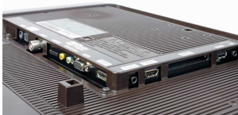
Samsungs Monitor-TV wartet mit einem Digitaltuner, mehreren HDMI-Eingängen und einem CI-Schacht auf.
