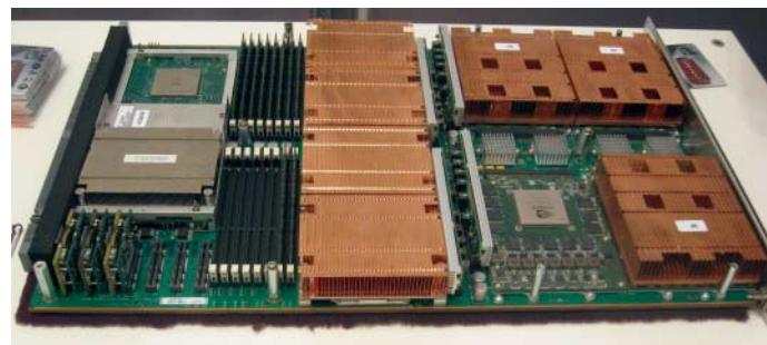
Beim Cray XK6-Board ist pro AMD-Interlagos-Prozessor eine Nvidia-GPU vorgesehen.
