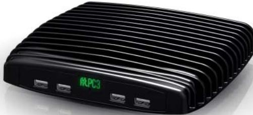
In der mit Kühlrippen versehenen Ausführung des fit-PC3 steckt ein 18-Watt-Prozessor.
