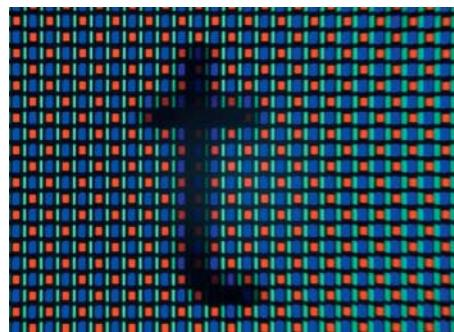
Auf den Displays des iPhone 4S (links) und des Galaxy Nexus (Mitte) erkennt man mit bloßem Auge keine Pixeltreppen – erst die 30-fache Vergrößerung zeigt die dichte Struktur. Auf dem Nokia Lumia (rechts) sehen Kanten nicht so scharf aus, da die Auflösung geringer ist. Das iPhone nutzt drei Subpixel pro Pixel, die anderen beiden nur zwei (PenTile-Matrix).
