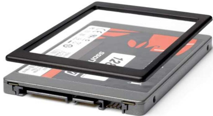
Kingstons SSDNow V200 mit JMicron-Controller liefert nur SATA-6G-Tempo light. Der beigelegte Kleberahmen verwandelt die schlanke 7-mm-SSD in ein 9,5-mm-Laufwerk.
