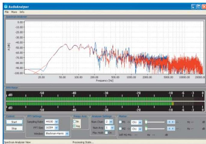
AudioAnalyser führt in Echtzeit eine FFT-Analyse des Musiksignals der Soundkarte durch.
