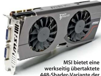
MSI bietet eine werkseitig übertaktete 448-Shader-Variante der GeForce GTX 560 Ti an.
