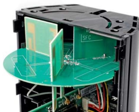
**D-Links DIR-645 erreicht seinen sehr guten WLAN-Durchsatz mit einem Array aus sechs Antennen, von denen er je nach Gegenstelle dynamisch die beiden mit dem besten Signal wählt.**
