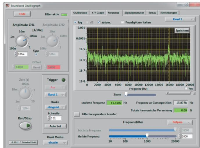
**Soundcard Oszilloskop untersucht Signale per Fourieranalyse und stellt sie als Frequenz- oder Wasserfalldiagramm dar.**
