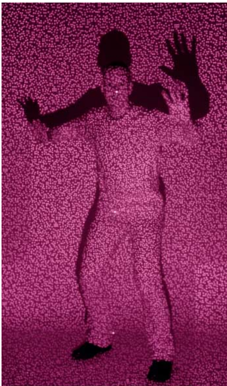
Die Infrarotlampe der Kinect wirft ein Punktmuster in den Raum. Ein spezielles von der Firma Primesense entwickeltes System on Chip (SoC) liest das Muster aus dem IR-Sensor aus und berechnet daraus ein Tiefenbild.
