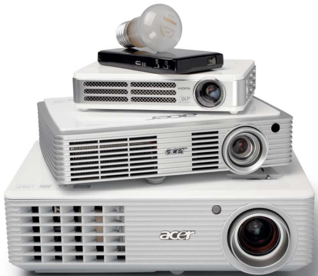
Größen- und Helligkeitsvergleich (von unten): Konventioneller DLP-(Lampen-)Beamer H5360 von Acer (2123 Lumen), LED-Modell K330 von Acer (393 Lumen), LED-Beamer Qumi von Vivitek (183 Lumen) und Laserprojektor Microvision ShowWX+ (11 Lumen).
