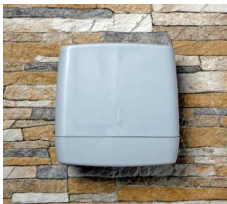
Osbridge 2Ni: dank hohem Antennengewinn auch gut für Richtfunkstrecken statt nur den Garten geeignet
