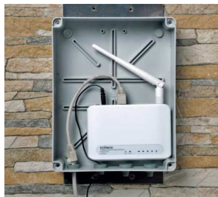
Edimax EW-7228APn im Outdoor-Gehäuse: Eigenbau außer Konkurrenz, niedrige Leistungsaufnahme bei gutem WLAN-Durchsatz
