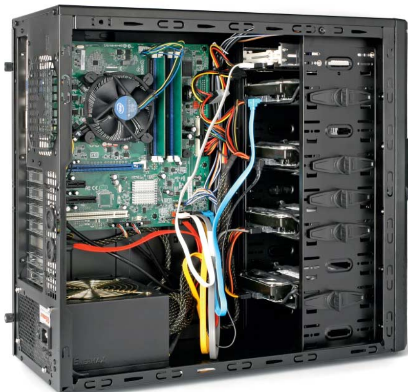
Die weiche Aufhängung der Festplatten ist ziemlich teuer, sorgt aber für Ruhe und lässt Luft zirkulieren.
