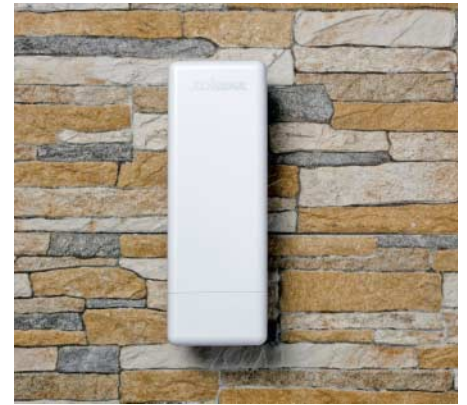
Edimax EW-7303APn: preisgünstig, Multi-SSID/VLAN-fähig, arbeitet mit zwei Ethernet-Ports auch als Breitband-Router
