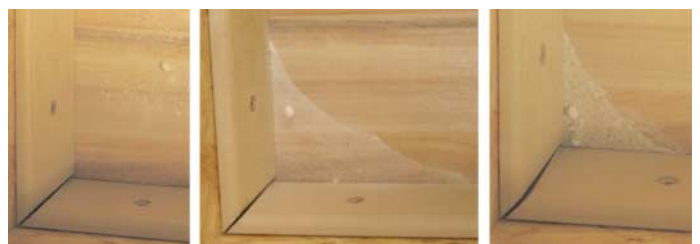
Ecken-Arbeit: Links Kärcher RC 3000, in der Mitte Deebot D56 und rechts die Reste, die Roomba und Co. zurücklassen.
