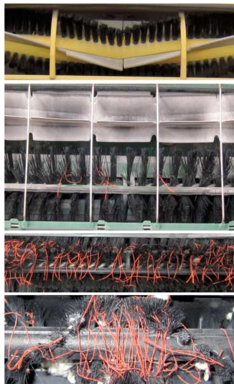
Bürsten nach der Reinigung: Der Samsung Navibot SR8855 oben hat dank seines kräftigen Saugers und der guten Bürstenform keines unserer Testhaare aufgewickelt. Auch gut: Der Roomba 564 PET von iRobot. Die dritte Bürste gehört zum Infinuevo, die vierte zum Kärcher RC 3000. Beide wickelten nahezu alle 100 Testhaare auf, statt sie in den Schmutzbehälter zu befördern.
