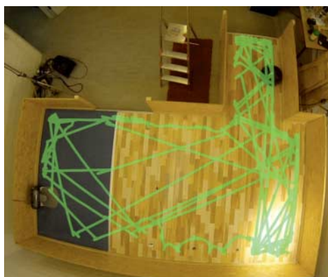
Im „Auto-Modus“ konzentriert sich der Deebot D76 zunächst auf die Randbereiche. Die Mitte des Raumes wird später abgearbeitet.
