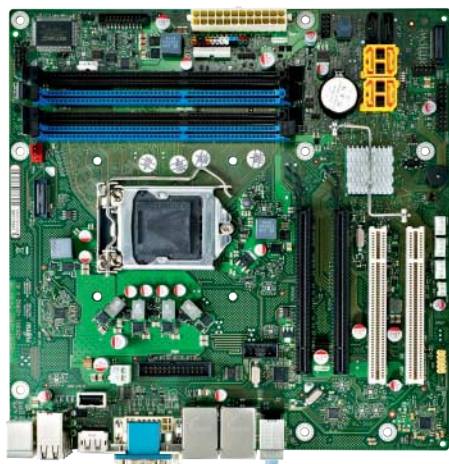
Robustes Industrie-Mainboard: Das D3071-S für Core-i-Prozessoren der zweiten Generation verkraftet bis zu 60 °C Umgebungstemperatur und lässt sich fernwarten.
