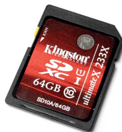
Die von einem stilisierten U umrandete Ziffer Eins steht für eine neue Geschwindigkeitsklasse bei SD-Speicherkarten: Ultra-Highspeed-(UHS)-I-Modelle schaffen theoretisch bis zu 104 MByte/s.
