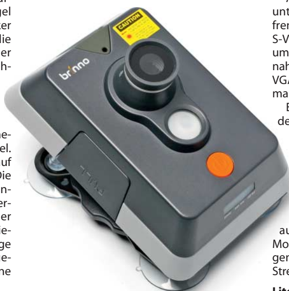
Die BirdWatchCam von Brinno lässt sich mit Saugnäpfen an der Fensterscheibe befestigen. Sie speichert Fotos auf SD-Karte.
