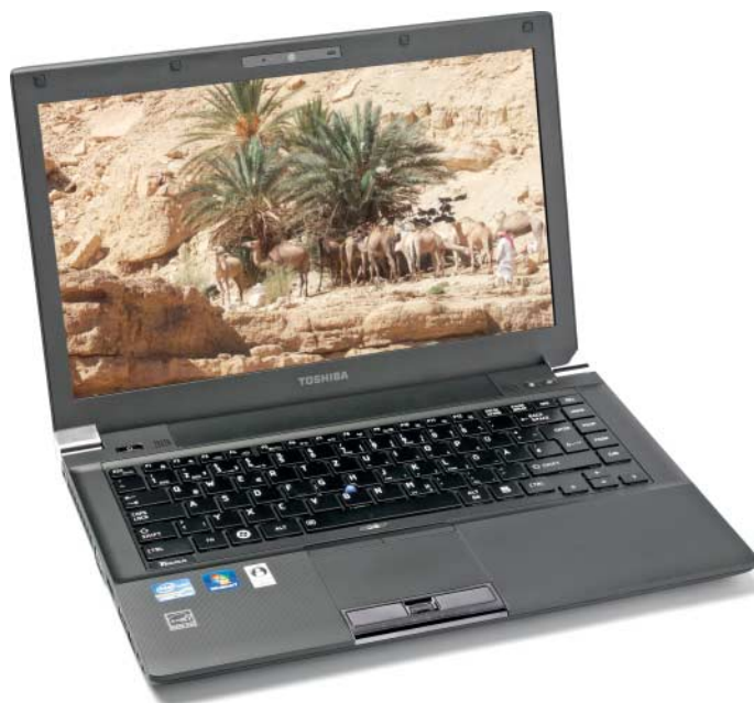
Der Hochkapazitätsakku von Toshiba's Tecra R840 hält zwar bis zu 13 Stunden durch, bockt das Notebook aber so stark auf, dass man den Bildschirm nicht mehr optimal im Blick hat.
