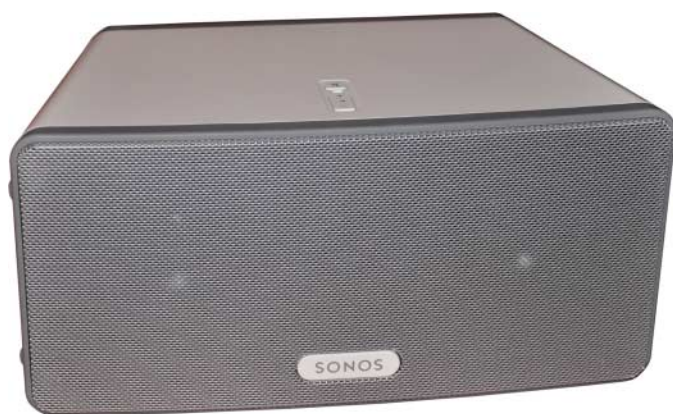
Einzige Bedienelemente am Sonos Play:3 sind – wie bei anderen ZonePlayern – Lautstärke- und Mute-Tasten.
