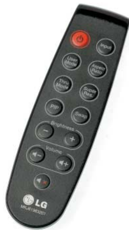
LG spendiert dem E2770V eine Mini-Fernbedienung, mit der sich wichtige Bildparameter einstellen lassen.
