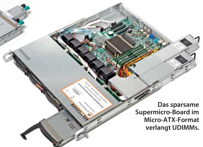
Zwei Radialventilatoren sorgen im Intel-Barebone für redundante Prozessorkühlung.
