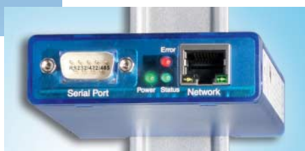
Der Com-Server++ bezieht seine Versorgungsspannung per Power-over-Ethernet und passt auf Hutschienen.
