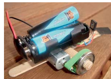
Dem Simplemobil dient ein Eisstiel als Chassis, zwei CD-Laufwerksmotoren treiben die Räder über Gummibänder an.
