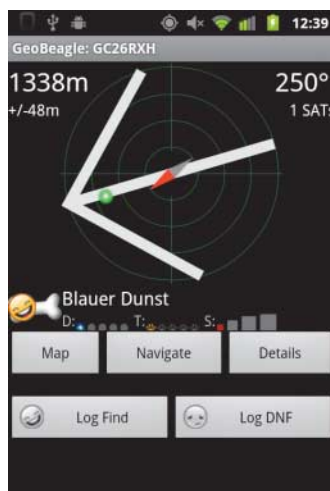
Keine Schönheit, aber funktional: Geobeagels Kompass zeigt die Genauigkeit des GPS-Fixes.
