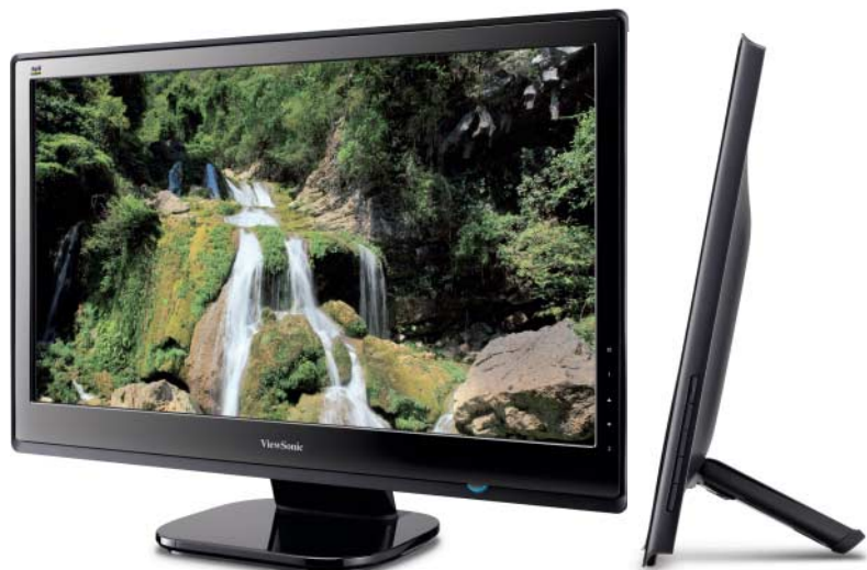
Entfernt man die Bodenplatte an Viewsonics VX2753mh-LED, steht der Schirm wie ein Bilderrahmen auf seiner Unterkante.
