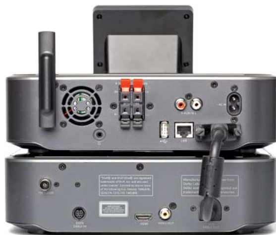
Die kombinierte Verstärker- und Streaming-Einheit der MCi8080 ist über ein Kabel mit dem optischen Laufwerk verbunden.
