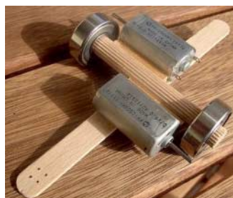
Dem Simplemobil dient ein Eisstiel als Chassis, zwei CD-Laufwerksmotoren treiben die Räder über Gummibänder an.
