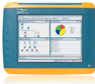
Flukes Netzwerkanalyse-Tablet-PC wiegt zwar mehr als manches Notebook, analysiert aber über zahlreiche Schnittstellen Kabel- und Funknetze und hilft bei der Fehlersuche.
