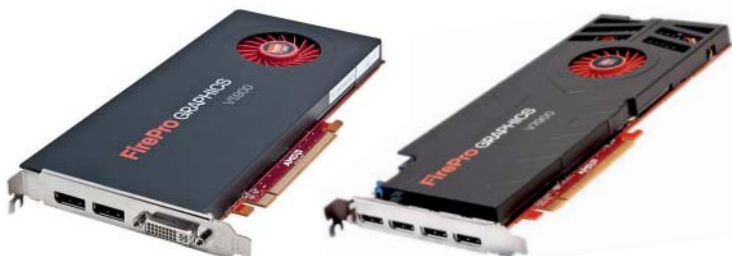
Die FirePro V5900 (links) bindet bis zu drei Displays gleichzeitig an, die V7900 gleich vier.
