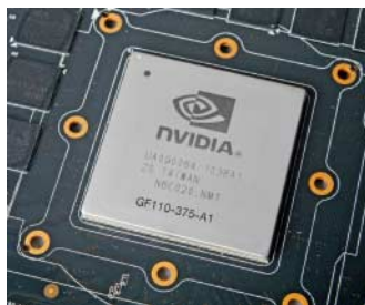
Der derzeit leistungsfähigste Grafikchip ist Nvidias GF110, der auf der High-End-Karte GeForce GTX 580 verbaut wird.
