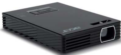
Acers Minibeamer C112 nutzt LEDs als Lichtquelle und passt in die Hosentasche.
