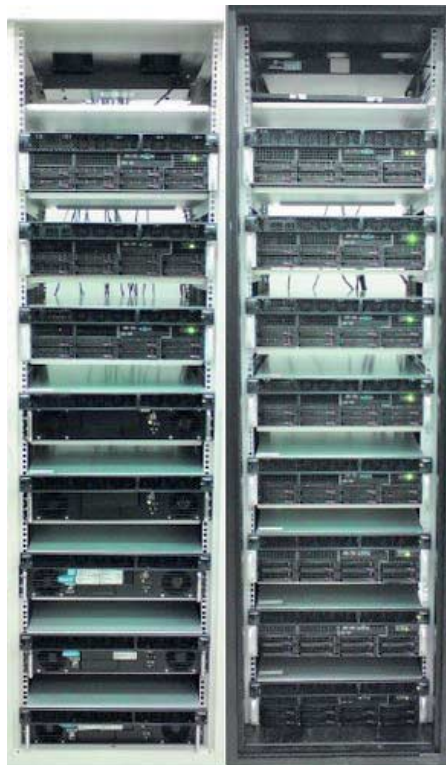
Crack-Rack: Zusammengeschaltete Tesla-Einschübe auf Grundlage von Nvidias Grafikprozessoren rekonstruieren schwache Passwörter in wenigen Sekunden.
