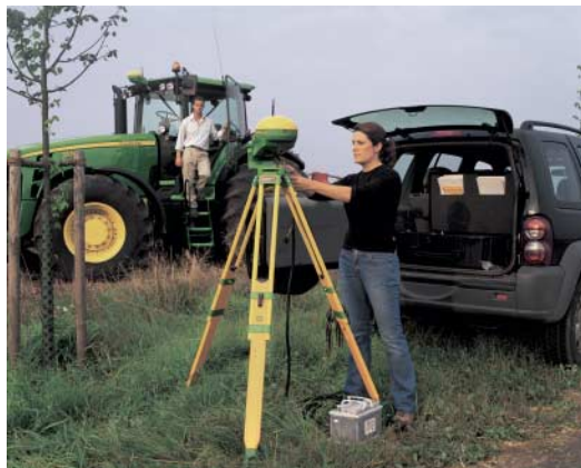
RTK-Stationen wie das StarFire-System von John Deere lassen sich auch in der Nähe eines Feldes aufbauen.
