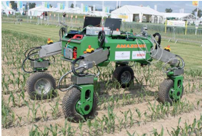
Der Feldroboter BoniRob kann autonom über einen Acker fahren und dabei Pflanzen individuell begutachten.
