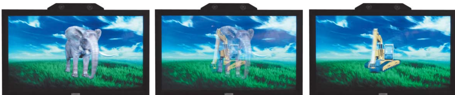
Zwei Bilder, ein LCD: Das Fraunhofer Heinrich Hertz Institut aus Berlin führte vor, dass ein brillenloses 3D-Display für zwei nebeneinander sitzende Betrachter unterschiedliche Bilder anzeigen kann (das mittlere Bild zeigt den Übergang).
