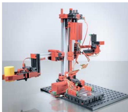
Kräftige Motoren und Aluminiumprofile sollen auch den Dauerbetrieb der Modelle ermöglichen.
