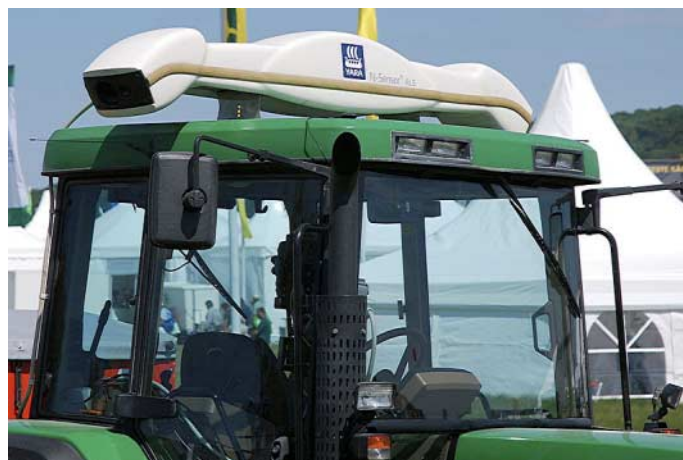
Ein montierter Yara-N-Sensor vom Typ ALS. Da diese Version mit Xenon-Blitzlampen arbeitet, können Messungen auch bei ungünstigen Lichtverhältnissen durchgeführt werden.
