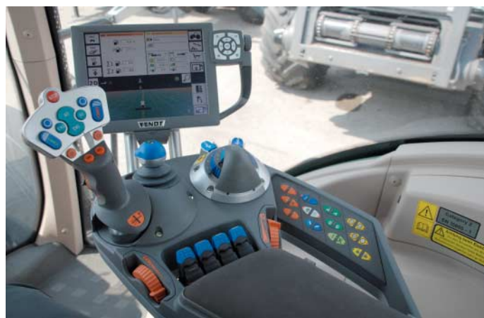
Die Variotronic-Bedienung von Fendt mit Multifunktionsarmlehne, Joystick und Touchscreen. Das Display lässt sich in bis zu vier Einzelfenster unterteilen. Im unteren Teil ist gerade die automatische Spurführung zugeschaltet.
