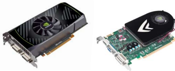
Die GeForce GT 545 mit GDDR5-Speicher (links) stattet Nvidia mit einem größeren Kühler aus. Das DDR3-Modell belegt nur einen Gehäusesteckplatz, ist aber auch langsamer.
