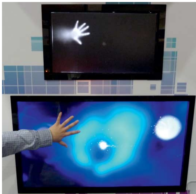
Samsungs Infrarot-Touch im 40"-LCD folgt schnellen Bewegungen auch mehrerer Hände problemlos, das obere LCD zeigt die IR-Aufnahme.
