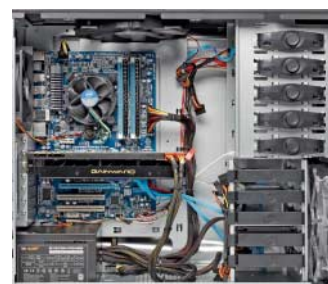
Übertaktet: Der Prozessor im Fuego-PC von Agando läuft mit 4 GHz, aber ohne Turbo Boost.
