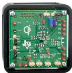
Mobilgeräte drahtlos aufladen: Die Stromübertrager von Texas Instruments erreichen dabei eine Effizienz von bis zu 93 Prozent.
