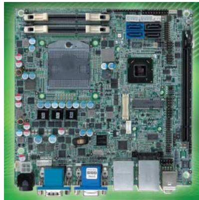
Das nur 17 cm × 17 cm große Mainboard KINO-QM670 nimmt einen Core-i-Prozessor für Notebooks auf.
