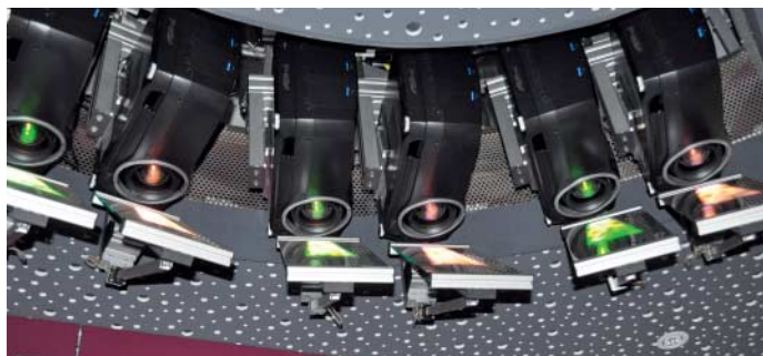
Das Licht der Projektoren strahlt nicht direkt auf die Leinwand, sondern nimmt den Umweg über Spiegel.
