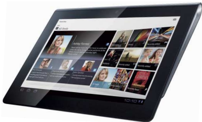
Sonys iPad-Konkurrent S1 läuft unter Android Honeycomb und zeigt auf 9,4 Zoll Diagonale 1280 × 800 Pixel. Das keilförmige Gehäuse soll den Bedienkomfort erhöhen.
