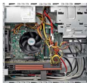
Geflickt: Acer umgeht beim Predator G3600 Intels Chipsatz-Bug durch Einbau eines SATA-Host-Controllers.
