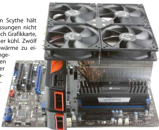
Der Scythe Susanoos setzt neue Maßstäbe: Nicht jedes Gehäuse ist für diese Kühlergröße gewappnet.
