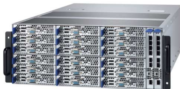
Tyan FM65-B5511: 18 Xeon-Server auf vier Höheneinheiten
