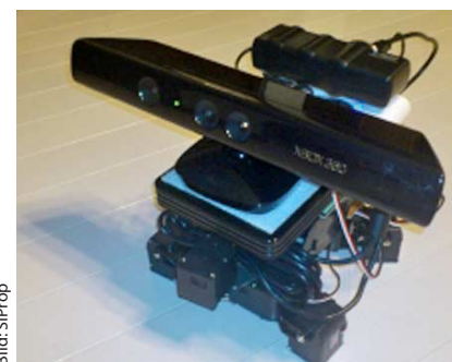
Der kleine Roboter der Firma SIProp erkennt mit seiner Kinect-Kamera Gesichter und krabbelt auf sie zu.
