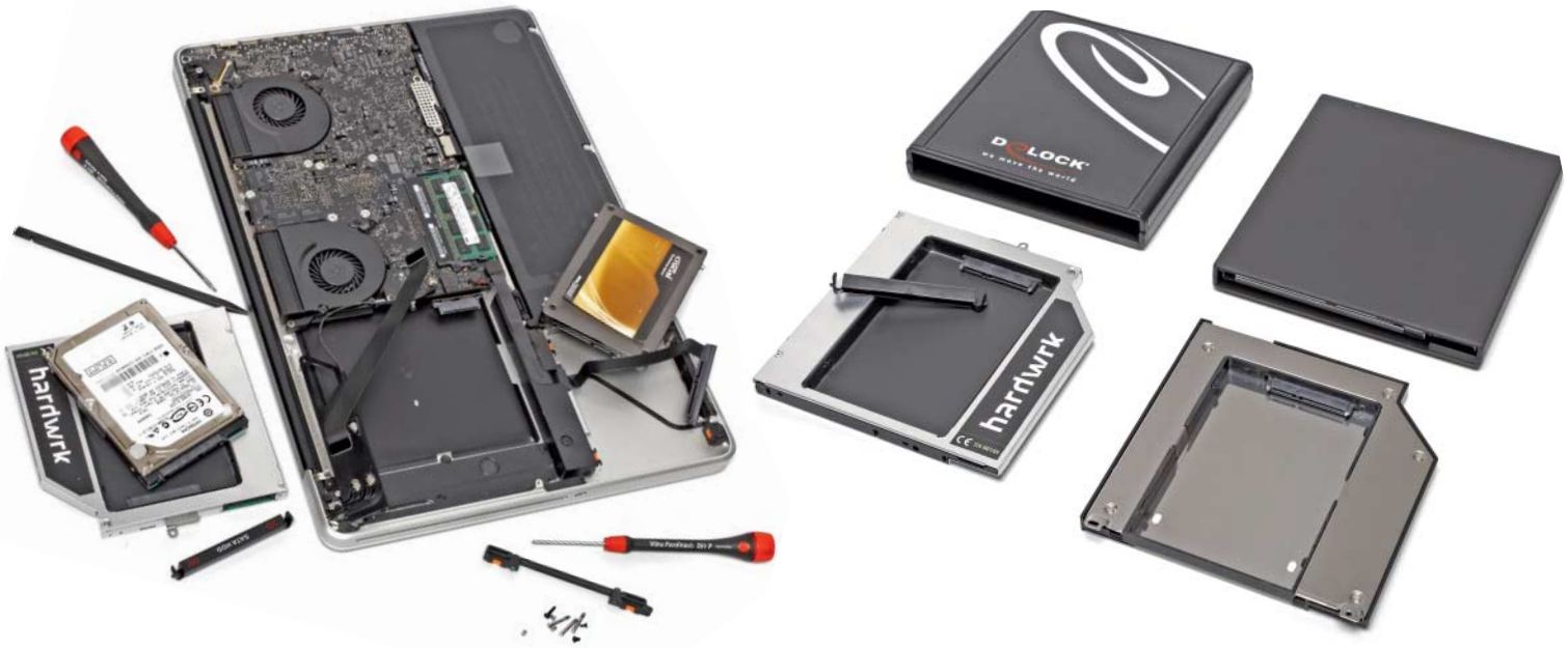
Die alte Festplatte kommt in einen Einbaurahmen an die Stelle des DVD-Brenners und schafft Platz für eine SSD.
