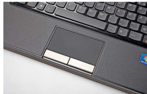
Edle Anmutung: Die Handballenablage von Lenovos Ideapad U260 ist mit Kunstleder überzogen, das Touchpad besteht aus mattiertem Glas.
