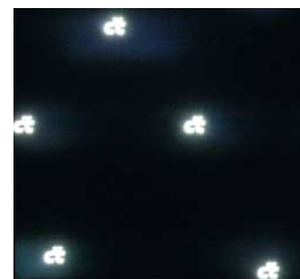
An hellen Bildstellen legt sich beim lokalen Dimmen oft eine Aura, teilweise wird auch mehr aufgehellt, als tatsächlich leuchten sollte (unten links).
