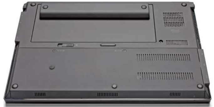
Der Sechs-Zellen-Akku von HPs ProBook 5320m steht an der Unterseite über; nur die schwächere Variante mit vier flachen Lithium-Polymer-Zellen schließt bündig mit dem Gehäuse ab.
