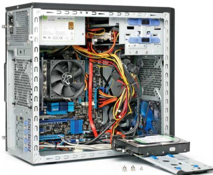
Der Mini-Tower QS-200 von AeroCool hat Platz für fast alle in einen Heimkino-PC benötigten Komponenten – nur ein HDD-Entkopplungsrahmen passt nicht rein.
