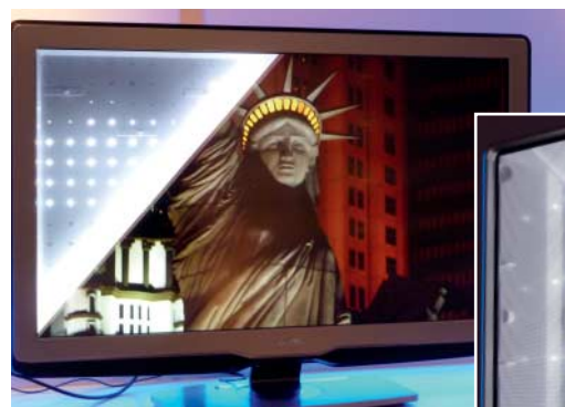
Direct-LED mit Local Dimming: Die flächig verteilten LEDs lassen sich in kleinen Blöcken separat ansteuern. Das steigert den In-Bild-Kontrast, die Ausleuchtung ist meistens gut.
