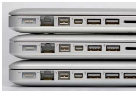
Am kleinen Blitz-Symbol erkennt man die neue Schnittstelle Thunderbolt.
