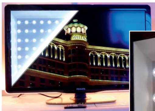
Direct-LED ohne Local Dimming: Die gleichmäßig im LCD-Rücken angeordneten großen LEDs werden gemeinsam angesteuert. Die Schirmausleuchtung ist meistens gut.
