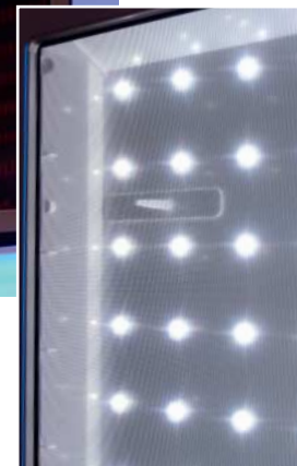
Direct-LED mit Local Dimming: Die flächig verteilten LEDs lassen sich in kleinen Blöcken separat ansteuern. Das steigert den In-Bild-Kontrast, die Ausleuchtung ist meistens gut.
