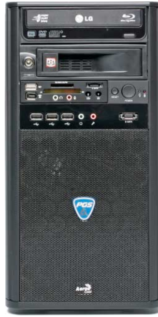
In den oberen Schächten stecken optisches Laufwerk und SATA-Wechselrahmen; darunter kommt der Kartenleser unter.
