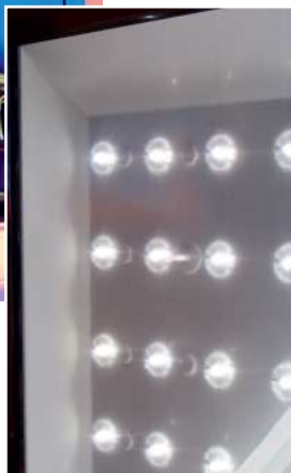
Direct-LED mit Local Dimming: Die flächig verteilten LEDs lassen sich in kleinen Blöcken separat ansteuern. Das steigert den In-Bild-Kontrast, die Ausleuchtung ist meistens gut.
