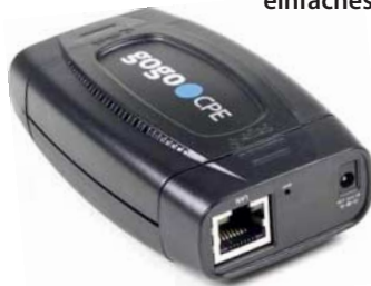
Die Zusatzbox gogoCPE bringt nur IPv4 sprechende Heimrouter und Netze ins IPv6-Internet – laut Hersteller durch einfaches Anstecken.
