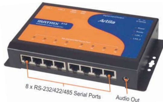
Die acht RJ45-Buchsen an der Front des Matrix-518 führen die seriellen Schnittstellen heraus. Die beiden LAN-Ports befinden sich an der Rückseite.
