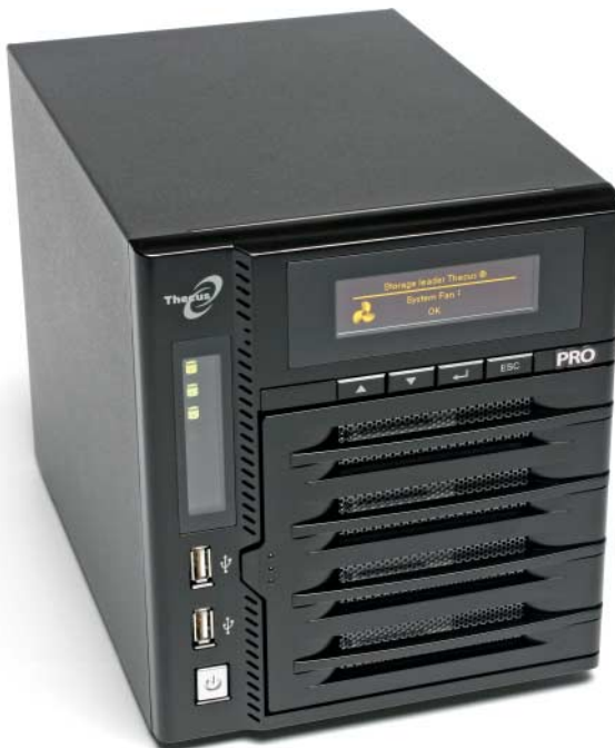
Thecus' N4200Pro erbt vom Vorgängermodell N4200 das Batteriemodul sowie einen Fehler in der Firmware, knackt beim Lesen jetzt aber immerhin die Marke von 100 MByte/s.
