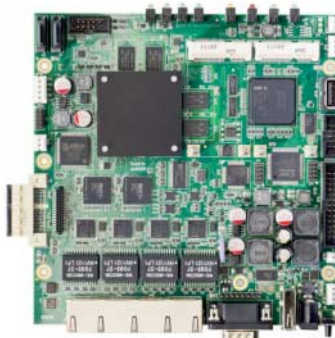
Soekris net6501: Single Board Computer mit Atom E
