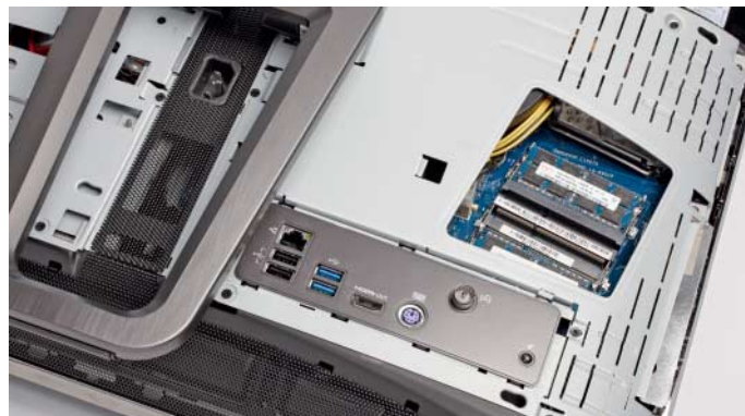
Der Arbeitsspeicher des Lenovo IdeaCentre B520 lässt sich mit vier SO-DIMMs auf bis zu 32 GByte erweitern.
