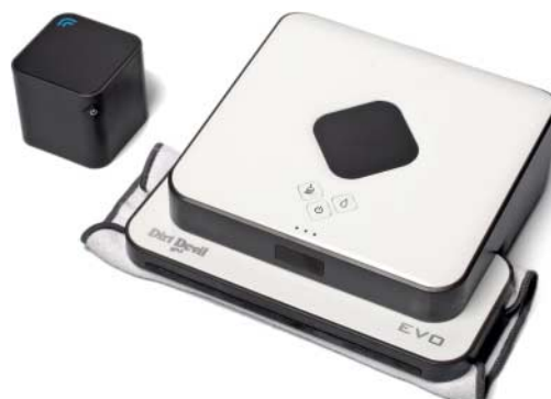
DirtDevil EVO M678: Mit „Indoor-GPS“ manövriert sich dieser Wischroboter durch den Raum.
