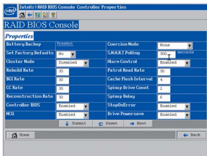
Das Firmware-Setup eines RAID-Adapters erlaubt detaillierte Einstellungen komplizierter Parameter.
