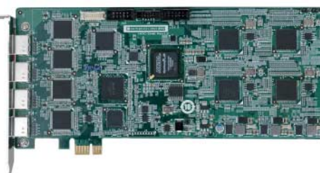
Die Capture-Karte HDC-304E verwandelt HDMI-Signale, die eigentlich für Displays gedacht sind, in H.264-Ströme.
