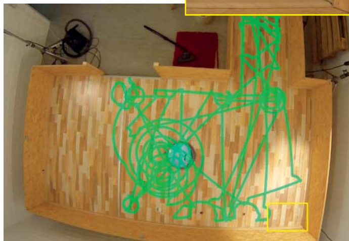
iRobot Scooba 385: Der Wischroboter hinterlässt nach wilder Fahrt ein reichlich gewässertes Laminat.
