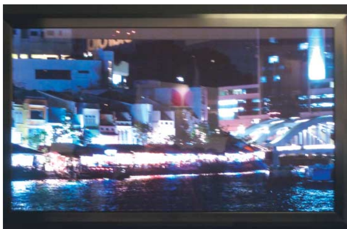
Mit Leuchtdiode, aber nicht organisch: Sonys Crystal LED Display hat die Vorteile der OLED-Technik und ist zugleich unempfindlich gegen Umwelteinflüsse.
