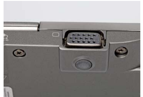
Toshiba baut den Netzwerkanschluss und den VGA-Ausgang in die hinteren Standfüße – an den schmalen Seiten haben sie keinen Platz.
