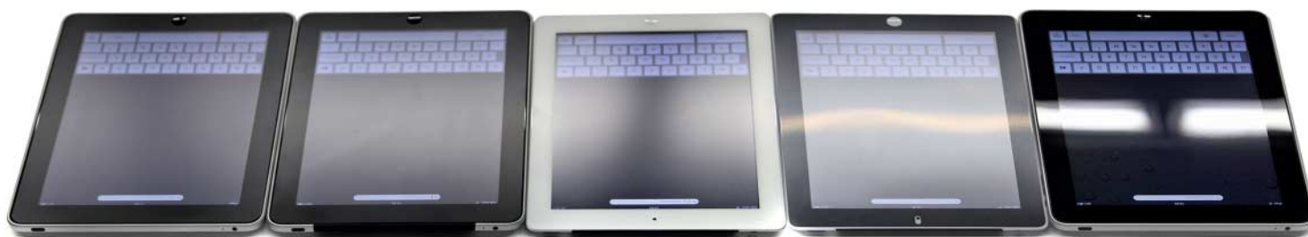
iPads unter gleicher Lichteinstrahlung mit Antireflexfolien von: Dipos, Folix, Belkin und Moshi; rechts ein iPad ohne Folie
