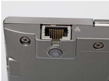
Toshiba baut den Netzwerkanschluss und den VGA-Ausgang in die hinteren Standfüße – an den schmalen Seiten haben sie keinen Platz.
