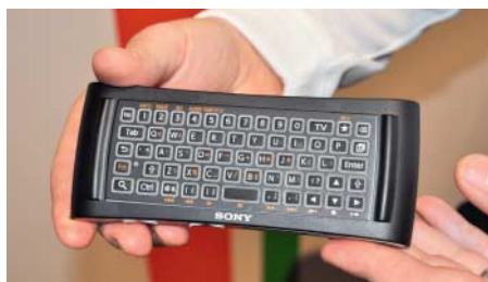
Sonys Google-TV-Controller: auf der einen Seite eine fast normale Fernbedienung (oben), auf der anderen eine Tastatur
