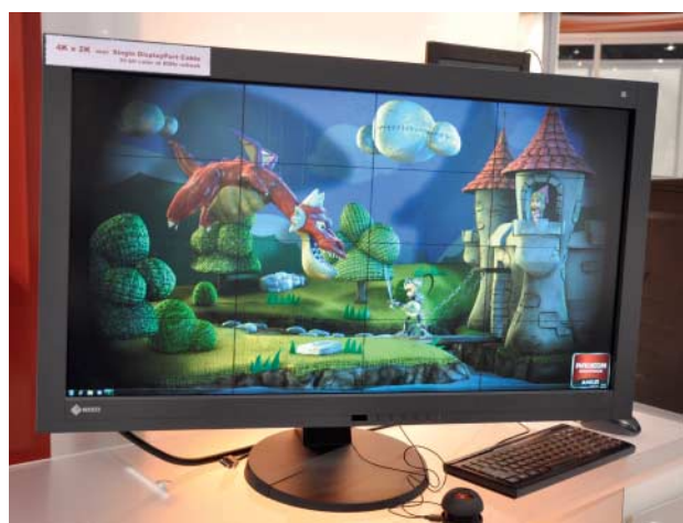
4K über DisplayPort: Da das verwendete Display nur über zwei DP-1.1-Eingänge verfügte, wurde eine Adapterplatine dazwischengeschaltet.
