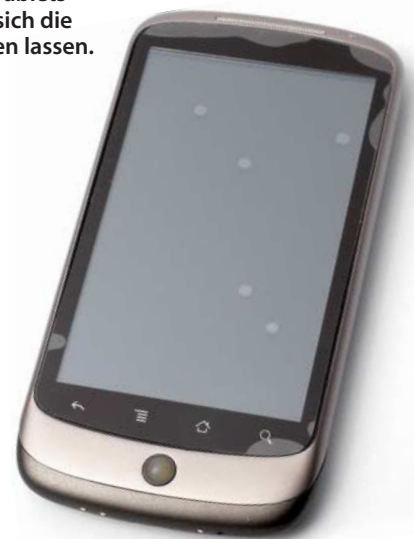
An den fünf kleineren Flecken hat sich beim Aufziehen der Folie Staub abgesetzt. Die hochgewölbten Kanten zeigen, dass die Folie etwas zu groß bemessen war.
