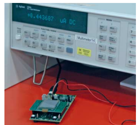
Im Stand-by soll der sparsamste Mikrocontroller der Welt mit nur 360 nA auskommen. Auf der Embedded World kam ein Prototyp des Wolverine bereits auf 443 nA.
