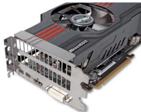
Durch ihr riesiges Kühlsystem belegt die Asus Radeon HD 7950 DirectCU II insgesamt drei Gehäusesteckplätze.
