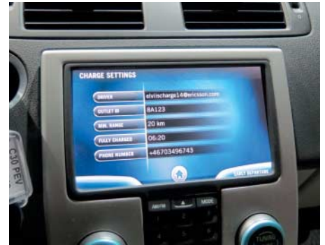
Über ein Bedienpanel stellt der Fahrer die Wunschrreichweite des Elektroautos für den nächsten Tag ein – egal, an welcher Steckdose das Fahrzeug geladen wird.
