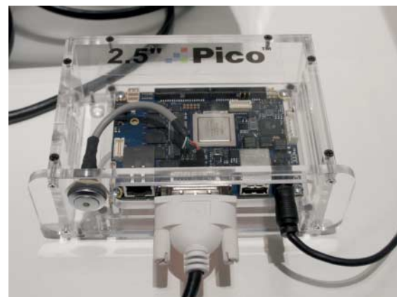
Auf dem winzigen Mainboard KTT20/pITX von Kontron soll Windows on ARM laufen.
