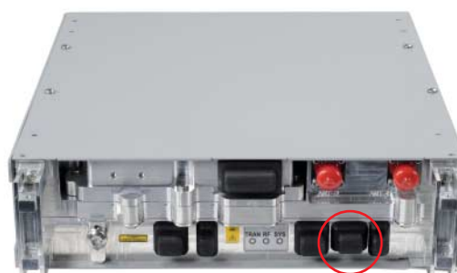
Einfach zugänglich für Netzbetreiber – aber auch für Schurken: LTE-Basisstation mit Ethernet-Uplink.
