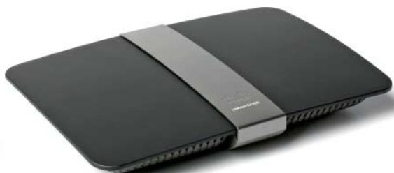
Cisco Linksys E4200v2: anderer Chipsatz als Version 1, deutlich besserer PPPoE-Durchsatz, Server-Funktionen auch im AP-Modus
