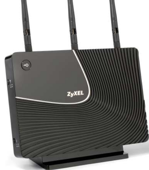
ZyXEL NBG5715: im Test mit schwacher WLAN-Performance im 5-GHz-Band und Port-Forwarding-Problemen, eingehende Diagnosemöglichkeiten per Root-Shell
