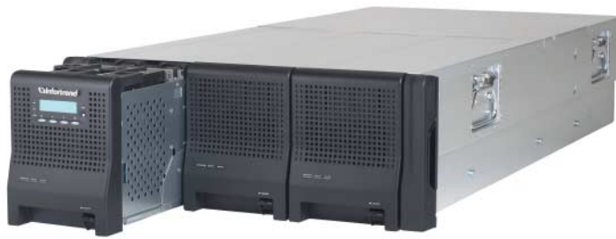
Infotrend packt 48 SAS-Disks in einen 4-HE-Einschub, der Daten via 8-Gbit/s-Fibrechannel liefert.
