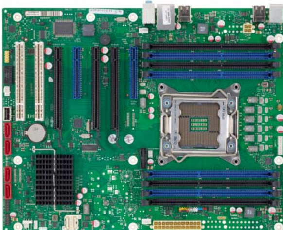
Der Xeon E5 passt auf LGA2011-Mainboards wie das Fujitsu D3128-B.
