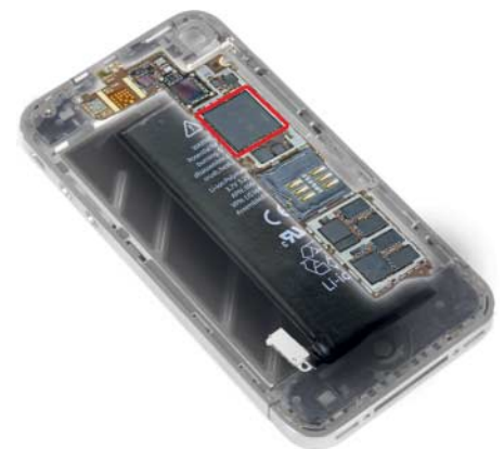
Herzstück eines Smartphones: Das System-on-Chip vereint Prozessor, GPU, Videobeschleuniger und viele weitere Funktionen in einem einzigen Bauteil.
