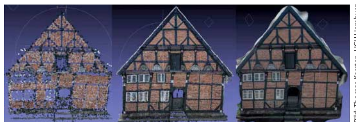
3D-Modelle des Alt-Segeberger Bürgerhauses, generiert aus 19 Einzelaufnahmen einer gewöhnlichen Digitalkamera: Die mit Hilfe von Photosynth erzeugte Punktwolke (links) ist unbrauchbar, Bundler (Mitte) und Photofly führen dagegen zu ansehnlichen Ergebnissen.
