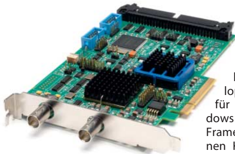
Schnelle Kamera-Ports: Die Karbon-CXP-Steckkarten empfangen über jeden ihrer CoaXPress-Ports Bilder mit bis zu 6,25 GBit/s.
