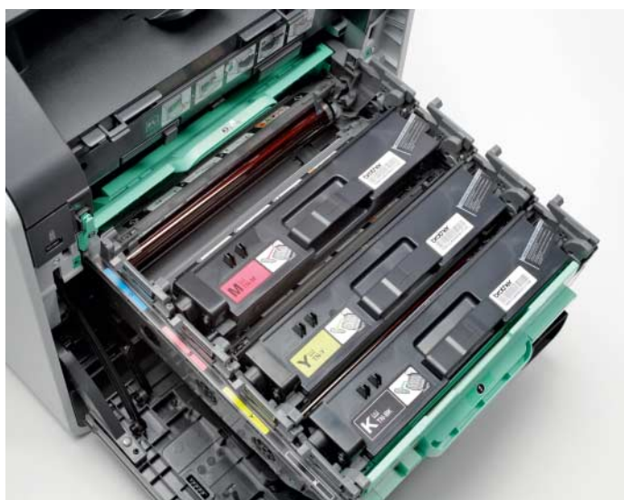
Die Tintenpatronen hinter einer Klappe an der Gehäusefront sind vergleichsweise leicht zu wechseln. Für den Kartuschenwechsel beim Laserdrucker muss man beim Brother-Gerät (links) tief ins Druckwerk greifen.
