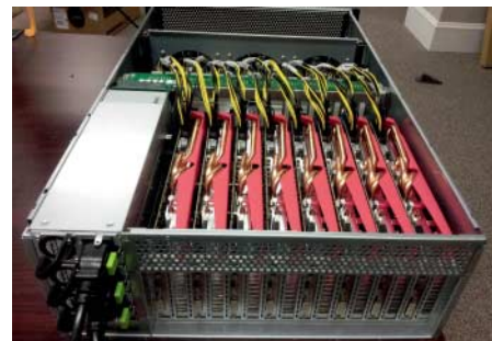
Fünf solcher Rechenserver (insgesamt 25 GPUs) hat ein Sicherheitsexperte zu einem Passwortknack-Cluster zusammengeschaltet.
