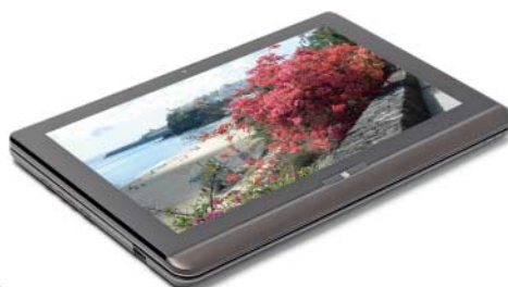
Bei Toshiba Satellite U920t verschiebt man Deckel und Unterbau gegeneinander und klappt den Bildschirm erst dann hoch. Ein besserer Bildschirm würde dem Gerät gut zu Gesicht stehen.
