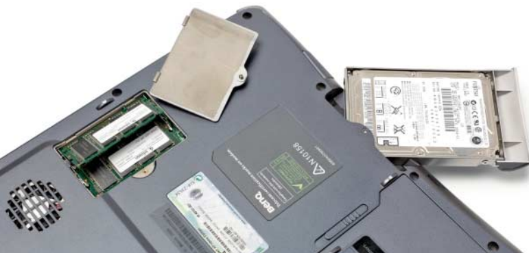
Notebooks mit Wartungsklappen lassen sich leicht aufrüsten, andere muss man aufwendig zerlegen.
