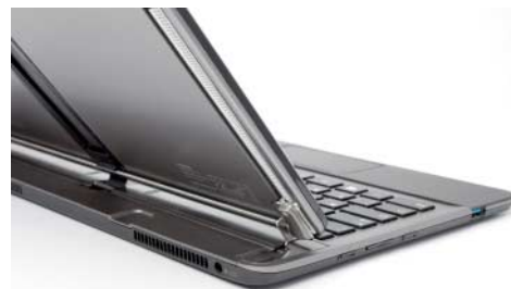
Bei Toshiba Satellite U920t verschiebt man Deckel und Unterbau gegeneinander und klappt den Bildschirm erst dann hoch. Ein besserer Bildschirm würde dem Gerät gut zu Gesicht stehen.
