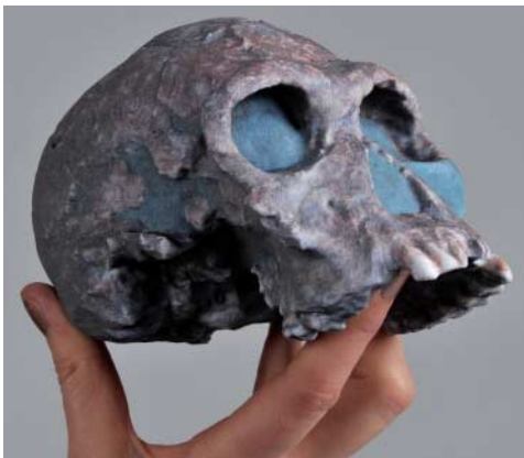
Dieser Schädel besteht aus bedruckten und dann aufeinandergeklebten Papierschichten, vollautomatisch aufgebaut vom 3D-Drucker Mcor Iris.
