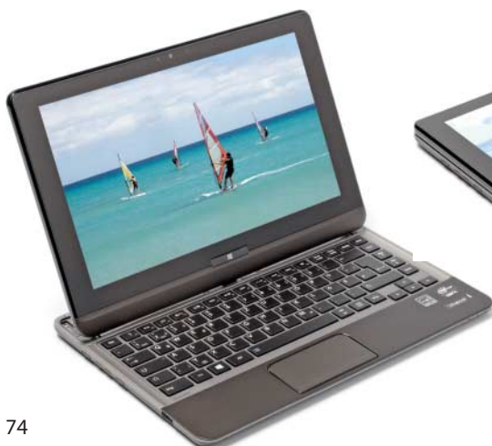
Bei Toshiba Satellite U920t verschiebt man Deckel und Unterbau gegeneinander und klappt den Bildschirm erst dann hoch. Ein besserer Bildschirm würde dem Gerät gut zu Gesicht stehen.
