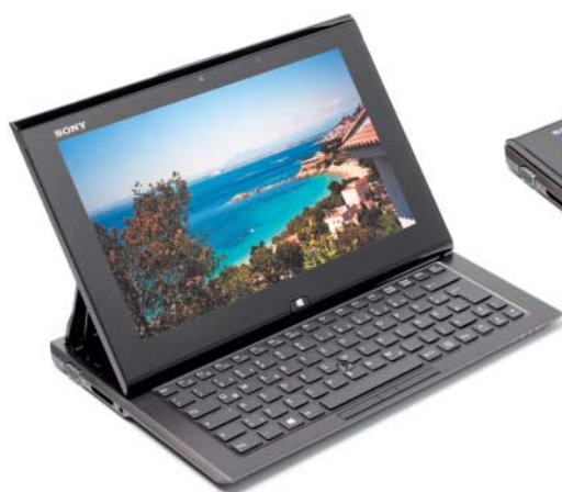
Sonys Vaio Duo 11 hat eine solide Klappmechanik, der Winkel des aufgestellten Touchscreens ist allerdings fix. Der Bildschirm überzeugt mit hoher Helligkeit, die Tasten sind arg klein geraten.
