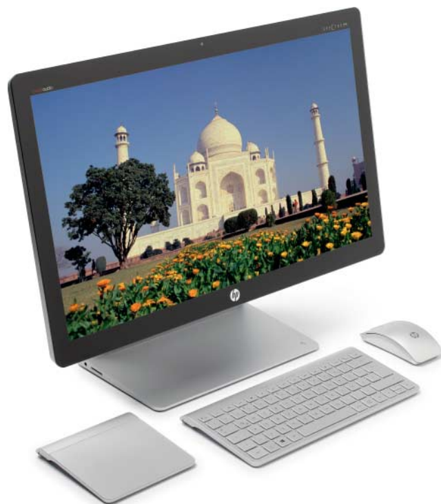
Im Fuß des HP Spectre One sitzt ein NFC-Sensor. Mit einem NFC-tauglichen Smartphone kann man sich darüber als Windows-Benutzer anmelden.
