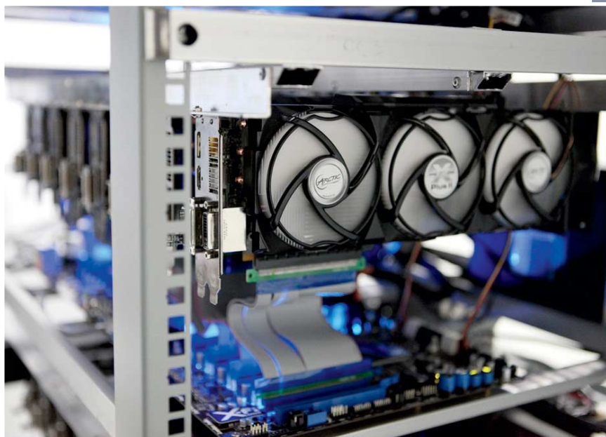
Geballte GPU-Kraft: Die Grafikkarten arbeiten dank PCI-Extender-Kabeln losgelöst von Mainboards und sind frei aufgehängt. Pro Rack lassen sich so 40 Grafikkarten, auf die oclHashcat-lite zugreift, optimal kühlen.
