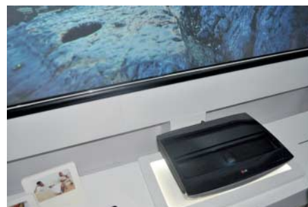
LGs „Laser TV“ entpuppt sich als Kurzstanzprojektor mit Laser-Lichtquelle. Die 100-Zoll-Leinwand wird mitgeliefert.
