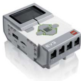
Die neue Schaltzentrale von Lego Mindstorms EV3 enthält einen ARM9-Prozessor und ein Betriebssystem mit Linux-Unterbau.
