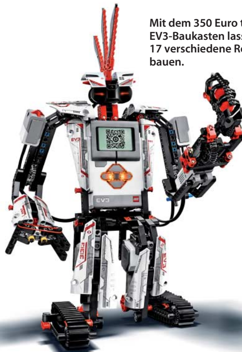
Die neue Schaltzentrale von Lego Mindstorms EV3 enthält einen ARM9-Prozessor und ein Betriebssystem mit Linux-Unterbau.
