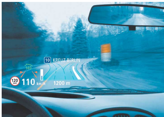
Osram will grüne Laserdioden auch für Head-up-Displays im Fahrzeug nutzen: Die auf die Windschutzscheibe projizierten Informationen liegen für den Betrachter in einiger Entfernung „vor“ dem Auto.
