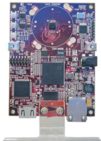
Prozessor, Speicher, Kamera: Das Embedded Vision Starterkit hat alles an Bord, was man für industrielle Bilderkennung braucht.
