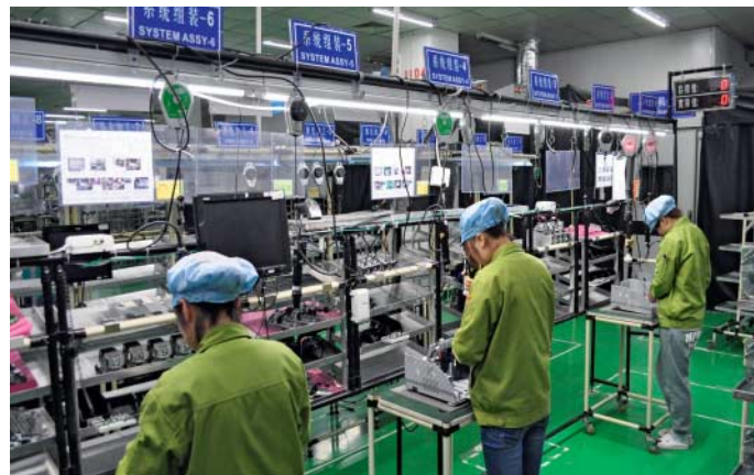
Alle Projektoren werden per Hand montiert; für jeden Arbeitsschritt ist die Taktzeit auf die Sekunde genau festgelegt.
