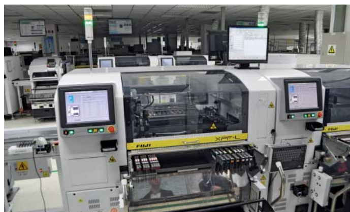
Dieser Automat bestückt 25 000 Komponenten pro Stunde, die Bauteile stecken aufgerollt in den Kartuschen vorne.
