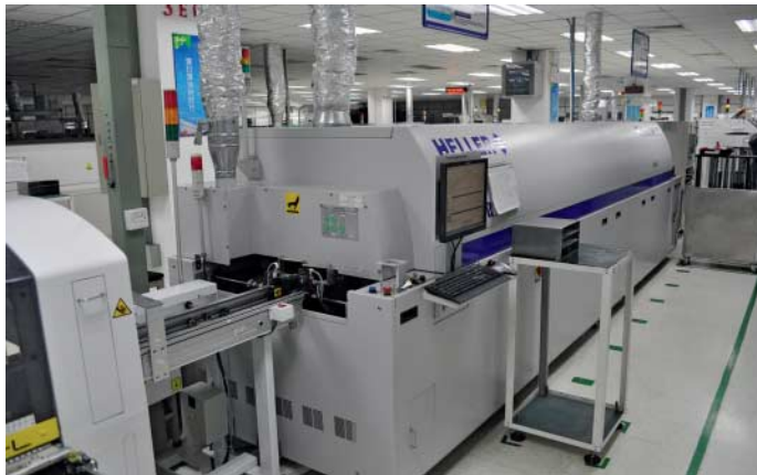
Gebacken: Die vom Bestückungsautomaten vorbereiteten Leiterplatten werden in diesem Reflow-Ofen verlötet.
