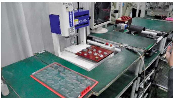
An diesem Arbeitsplatz werden die Farbräder geklebt und geschliffen. Links: ein Tablett mit Mulden für die einzelnen Glassegmente
