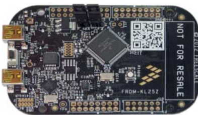
Internet der Dinge für 10 Euro. Das verspricht Freescale mit dem zu ARMs mbed-Konzept kompatiblen Freedom-Board. Darauf sitzt ein KL25-Prozessor mit Cortex-M0+-Kern.
