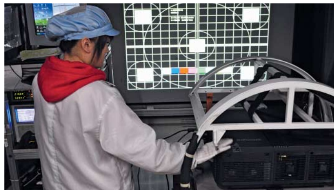
Noch vor der Montage überprüfen und kalibrieren Mitarbeiter jedes einzelne optische System.
