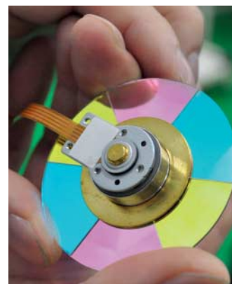
Die einzelnen Glassegmente der DLP-Farbräder schneiden Delta-Mitarbeiter manuell aus und verkleben sie anschließend.
