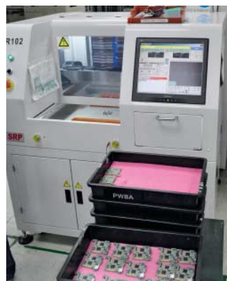
Hier werden Leiterplatten visuell auf Fehler untersucht – der Computer vergleicht das Bild jeder Platine mit einem Referenzfoto.
