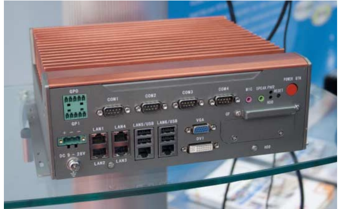
Lüfterlos und besonders zuverlässig: Das reklamiert die chinesische Firma Norco für ihre Industrie-PCs, hier ein Modell mit Core-i7 aus der Ivy-Bridge-Generation.
