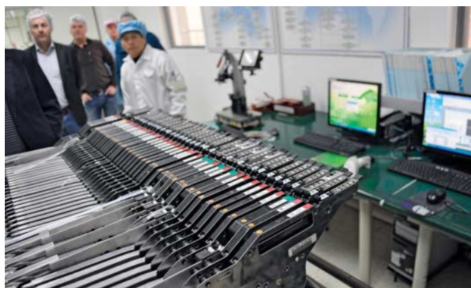
Jede Kartusche („Feeder Reel“) enthält bis zu 7000 Bauelemente.
