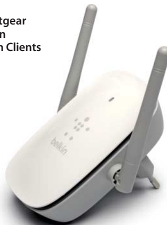
Schnellstarter mit üblicher WLAN-Bremse: Der Belkin F9K1111v1 lässt sich zwar im Handumdrehen einrichten, von den beiden Funkbändern macht er aber nur unvollständig Gebrauch.
