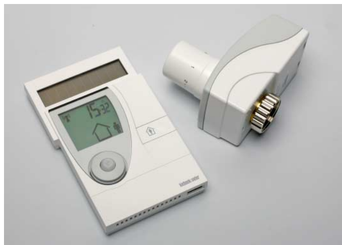
Der automatische Thermostat von Peter&Kieback gewinnt Energie aus der Hitze des Heizkörpers. Eine Solarzelle speist die dazugehörige Steuereinheit, die per Bewegungsmelder ein Nutzungsprofil des Raums erstellt und die Temperatur danach regelt. Energiespareffekt: bis zu 15 Prozent.
