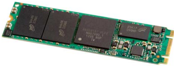
SSDs im kompakten Format namens M.2 sind für Ultrabooks mit Haswell-Prozessoren gedacht.
