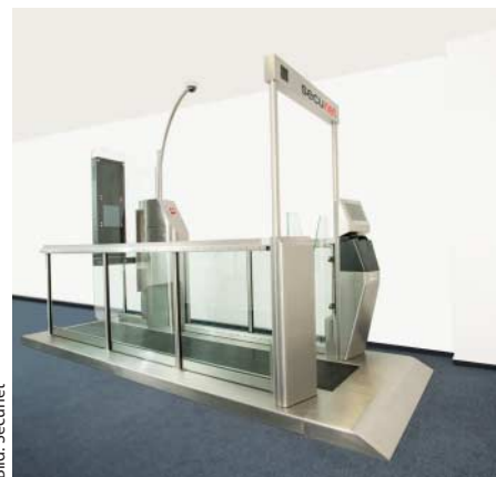
ABC-Spur des Essener Unternehmens Secunet. Nach Einlesen der Passdaten und einem positiven Bildabgleich öffnet sich eine Schleusentür und der Passagier kann weitergehen.
