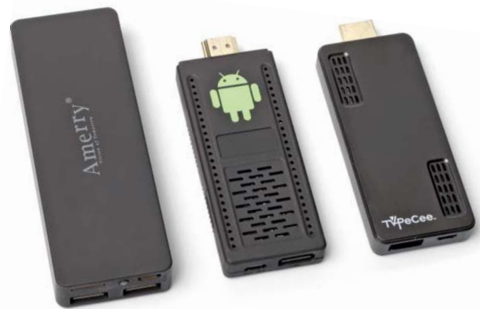
Drei HDMI-Androiden sind mit einer Dualcore-CPU ausgestattet: Der Amerry Android Smart-TV-Stick 2.0, Motioncodings Nova und der über Pearl vertriebene TVPeCee MMS-874.Dual-Core ...
