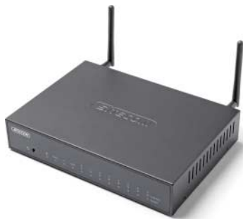
Der Sitecom WLR-4002B ist mit 8 Ethernet-Ports überdurchschnittlich bestückt.
