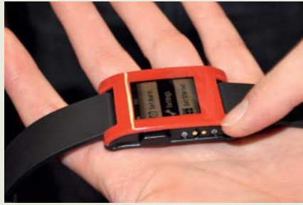
Die E-Paper-Uhr Pebble wird über vier Drucktasten bedient.
