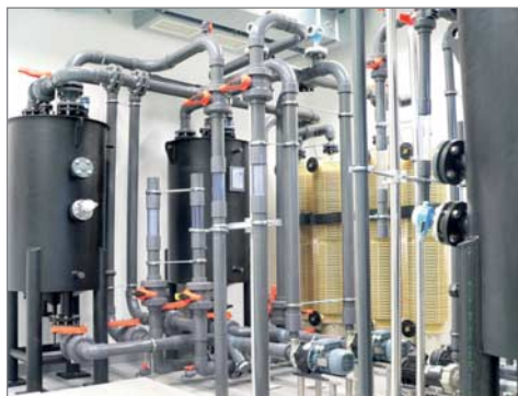
Redox-Flow-Testumgebung mit Elektrolytbehältern und Wärmetauschern beim Fraunhofer-Institut für Umwelt-, Sicherheits- und Energietechnik
