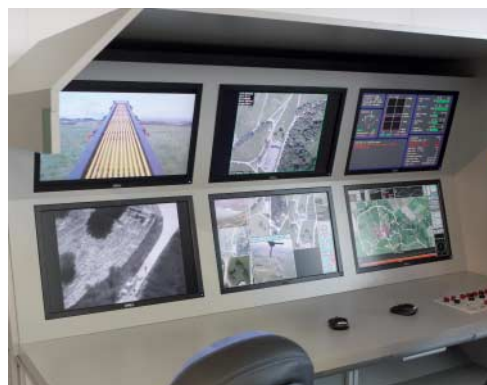
Drohnen-Arbeitsplatz der Bundeswehr: Live-Bilder der Kameras werden durch digitales Kartenmaterial und Zustandsinformationen des Fluggeräts ergänzt.
