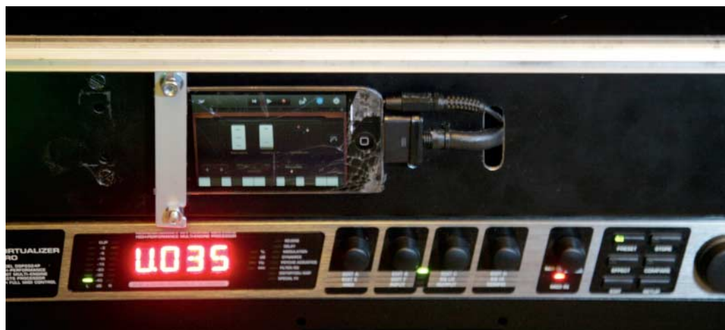
Ein gebrauchter iPod mit gesprungenem Glas kann in einem Rack noch gute Dienste als Klang-Erzeuger oder MIDI-Router leisten.
