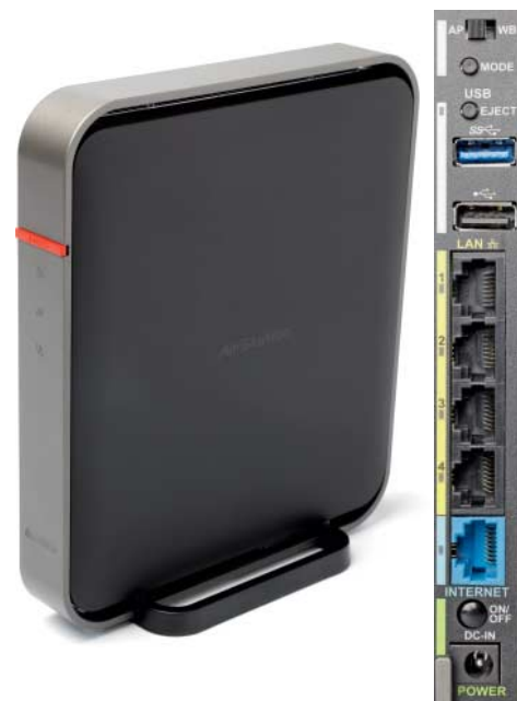
Buffalo WZR-1750DHP: gut ausgestattet, hoher NAT-Durchsatz, aber umständlicher Wechsel zwischen Router- und Access-Point-Modus
