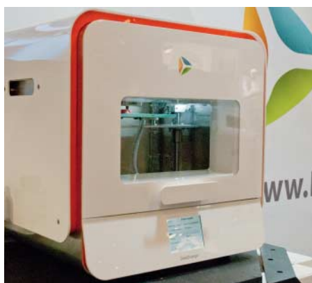
Beim DeeOrange soll ein spezieller Klebstoff für die Haftung der Werkstücke auf dem Drucktisch sorgen.
