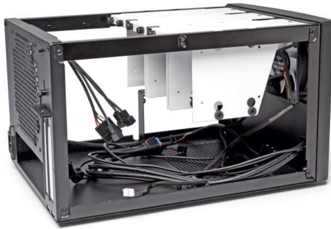
Das Node 304 nutzt den wenigen Platz optimal aus: Ungeachtet der kompakten Bauform bringt Fractal Design sechs Festplatten und ein ATX-Netzteil unter.
