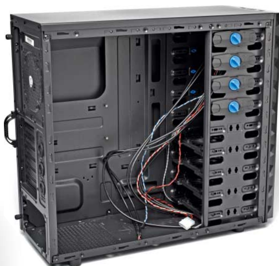
Das preiswerte Gehäuse Sharkoon REX8 Economy nimmt bis zu acht Festplatten in Entkopplerrahmen auf.
