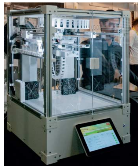
Den RepRap Industrial von Kühling & Kühling steuert ein großer Touchscreen.
