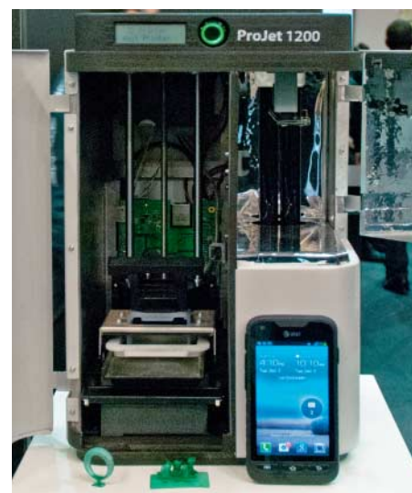
Mit dem ProJet 1200 hat 3D Systems einen Mini-Stereolithografiedrucker im Angebot. Das Telefon rechts vorne gehört nicht zum Gerät, sondern dem Produktmanager.
