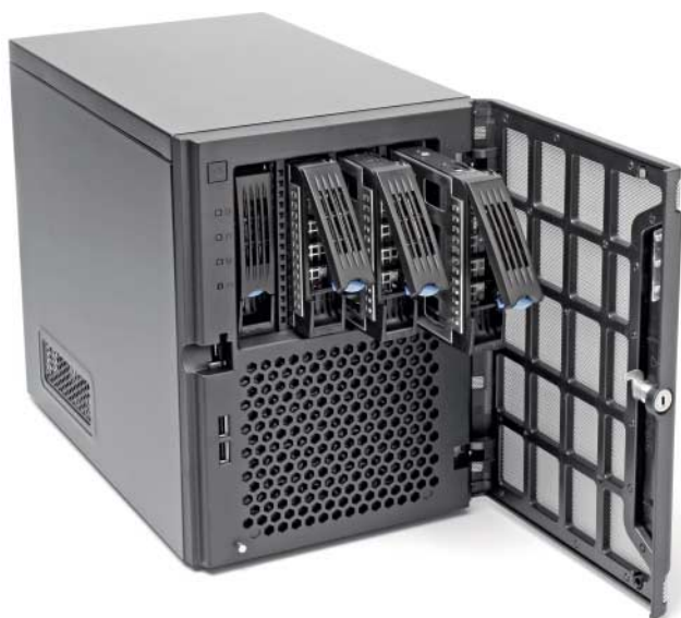
Mit NAS-Funktionen wie Hot-Swap-Rahmen oder Fehler-LED ist das Chenbro SR30169 ausgestattet. Die hohe Stabilität und Spezialfunktionen haben aber ihren Preis: 120 Euro.
