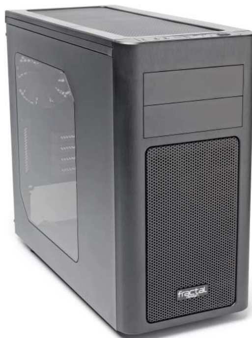
Trotz Beschränkung auf Micro-ATX-Boards hat das Fractal Design Arc Mini 2 die Abmessungen eines Full-Size-ATX-Gehäuses. Die Festplatten sitzen auf quer eingebauten Schlitzen.
