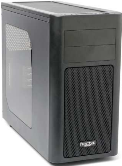
In das Fractal-Design-Gehäuse Arc Mini passen sechs Festplatten, aber nur Micro-ATX-Mainboards.
