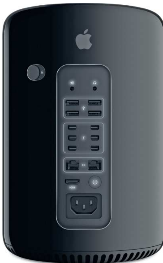
Der neue Mac Pro bietet viele Schnittstellen wie sechs Mal Thunderbolt 2.0 und vier Mal USB 3.
