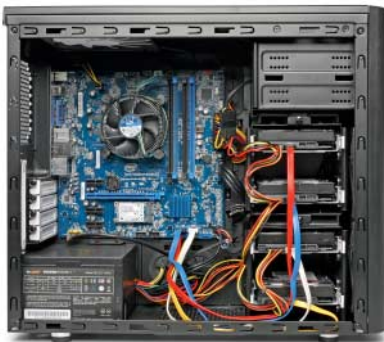
Bunte SATA-Kabel erleichtern die Zuordnung von Platten und Anschlüssen.
