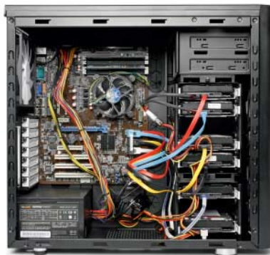
Jeweils mit Abstand eingebaut, bleiben die Platten oft auch ohne Gehäuselüfter kühl.
