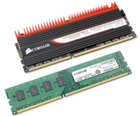
Lieber meiden: Übertakter-Module mit Blechdeckel und XMP-Konfiguration (oben).
