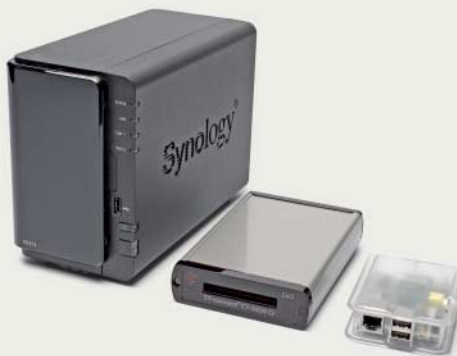
Ein DVB-Empfänger wie der TT-Connect CT-3650 CI macht aus manchen NAS-Boxen Videorecorder, zum Beispiel aus Synologys DS214. Der Minirechner Raspberry Pi verfüttert das TV-Signal dann an den LCD-Fernseher.
