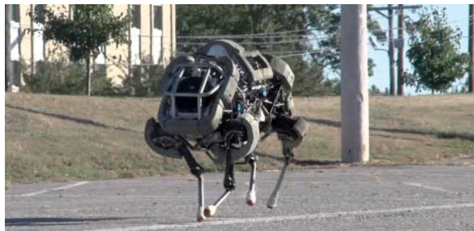
Moderner Lastenesel: Die vierbeinige WildCat von Boston Dynamics gilt mit einer Spitzengeschwindigkeit von fast 50 km/h als derzeit schnellster Laufroboter der Welt.
