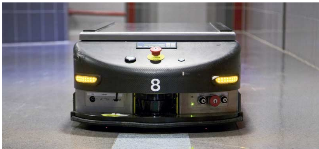
Der autonome Krankentransporter „Transcar LTC 2“ von Swisslog kann bis zu 500 Kilogramm schwere Container bewegen.
