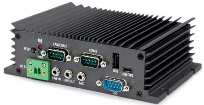
Der lüfterlose ARM-PC AMOS-820 steckt nicht nur einiges an Vibrationen weg, sondern verkraftet auch Hitze und Kälte.
