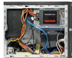
Drangvolle Enge im Mini-ITX-Case, aber es passt ein leises Standardnetzteil hinein.
