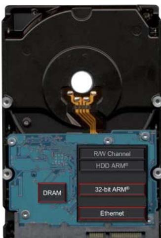
Server-Funktionen direkt auf dem Platten-Controller: Ethernet-Festplatte von HGST
