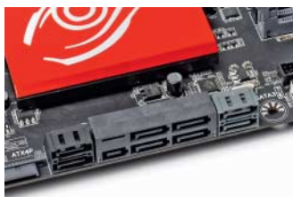
Einige Serie-9-Mainboards bündeln zwei SATA-6G-Ports mit einem Stromanschluss zu einer frühen Version von SATA Express.
