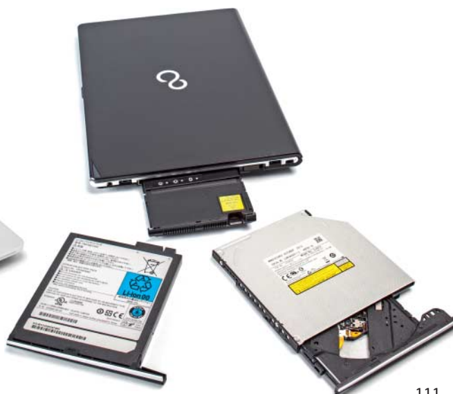
In den Wechselschacht der LifeBook S904 passt ein optisches Laufwerk, ein Zweitakku für mehr Laufzeit oder ein Mini-Beamer für Präsentationen in kleiner Runde.
