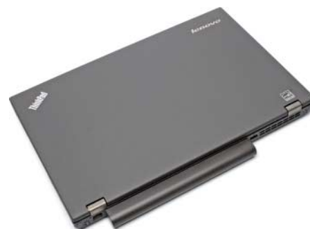
Die Testkonfiguration des Lenovo ThinkPad T540p wird mit einem überstehenden Hochkapazitätsakku geliefert.
