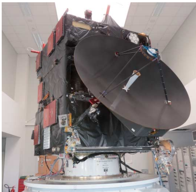
Auf dem Gelände der ESA in Darmstadt steht dieses flugfähige 1:1-Engineering-Modell der Rosetta-Sonde, das bis heute für Trainingseinheiten des Flight Control Teams genutzt wird.
