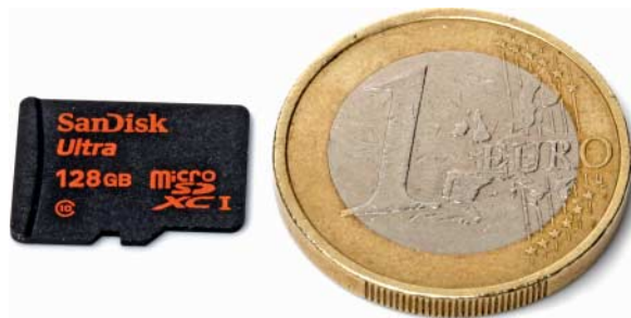
Die 1 Millimeter flache Micro-SD-Karte mit 128 GByte enthält 16 dünn geschliffene 64-GBit-Dice plus Controller-Die.
