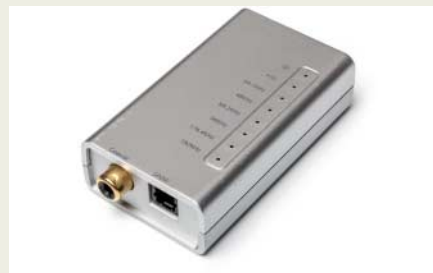
Bis zu 192 kHz Abtastrate verträgt dieser digitale USB-Soundadapter von Inline. Der Raspi schafft es schon bei 96 kHz nicht, ihn ohne Aussetzer zu füttern.
