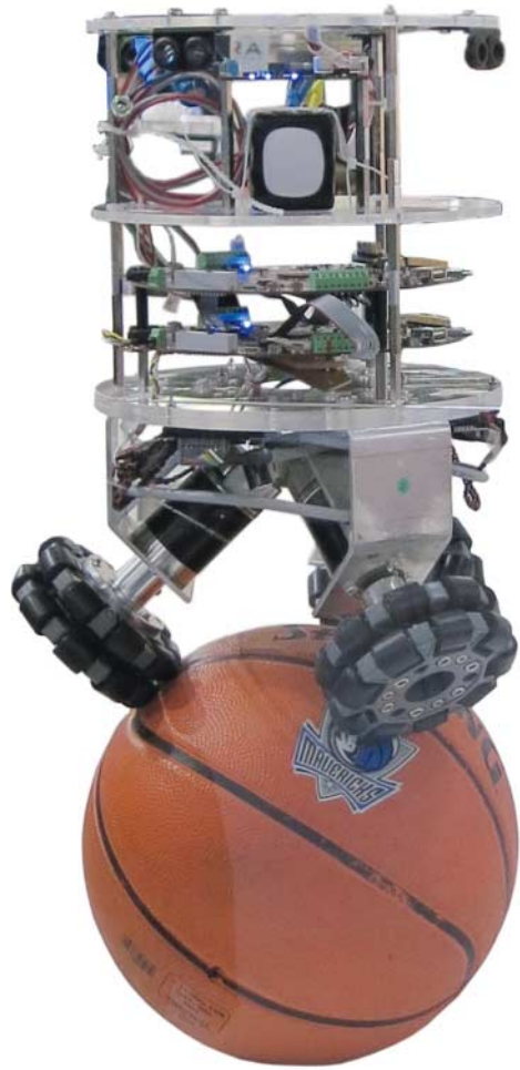
Eine Millisekunde verschlafen oder mal etwas länger nachdenken? Beides darf dem balancierenden Roboter nicht passieren, sonst fällt er von seinem Ball. So hart kann Echtzeit sein.
