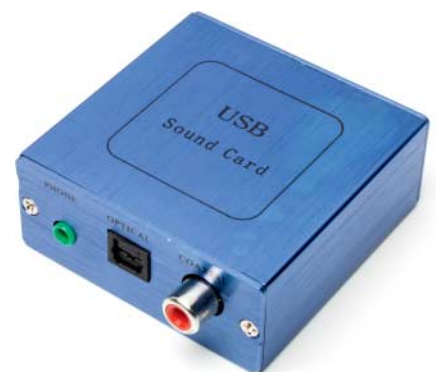
In vielen No-Name-Soundkistchen steckt der recht ordentliche DAC PCM2704 von Texas Instruments.
