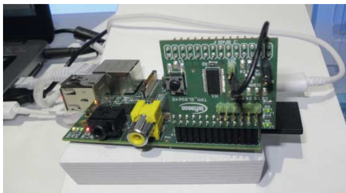
Sicherheitsgurt für Bastler: Infineon zeigte ein Trusted Platform Module für den Raspberry Pi.
