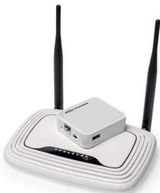
Ein Freifunk-fähiger Router wie der TL-WR841N (unten) ist schon ab 16 Euro zu haben. Nach Implantieren der Freifunk-Firmware schließt man ihn an den vorhandenen Internet-Router an.
