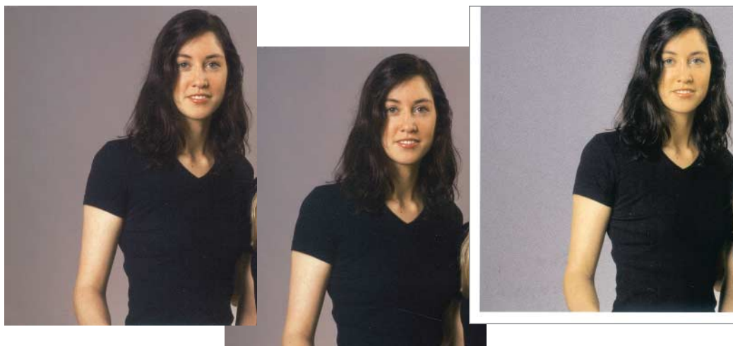
Beim Fotodruck haben die Open-Source-Treiber (rechts) für den Canon MX725 abgesehen von der Farbwiedergabe auch Probleme mit dem Randlosdruck. Die Linux-Treiber von Canon (links) drucken abgesehen von einem Hauch mehr Rot genauso gut wie die für Windows (Mitte).
