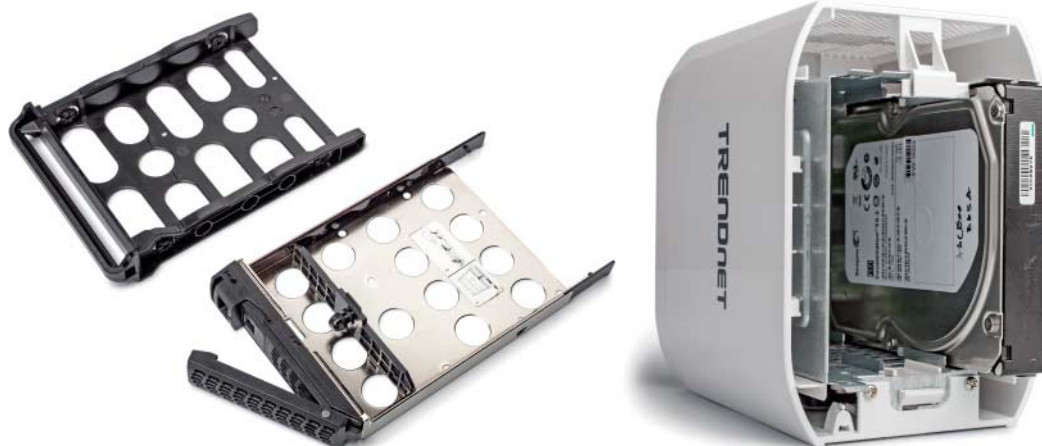
Dank Schnellwechselrahmen lassen sich Festplatten leicht einbauen, manchmal auch 2,5-Zoll-Versionen in 3,5-Zoll-Schächte. Manche NAS nehmen Platten ohne Rahmen auf.
