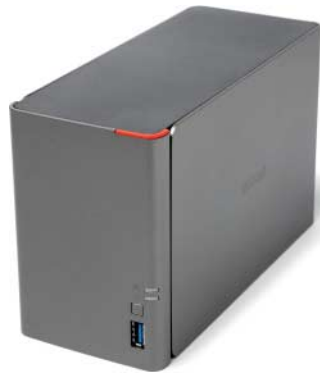
Buffalo LinkStation 421: heikle Inbetriebnahme im Test, brauchbarer Durchsatz, akzeptierte keine 8-TB-Platten
