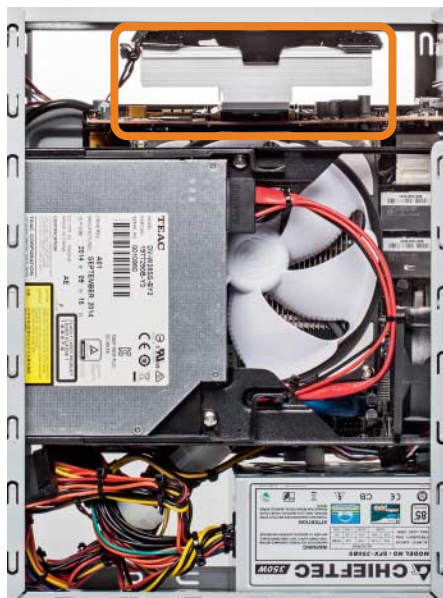
Im Inneren der Video EloX geht es extrem eng zu. Trotzdem fand Q.E.D. Platz, um der Profigrafikkarte einen besonders leisen Spezialkühler zu spendieren.
