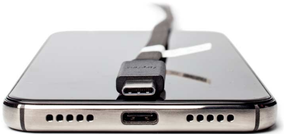
Der neue USB-Stecker Typ-C beim Gigaset ME ist genauso groß wie die alten Micro-USB-Anschlüsse, passt aber auch verdreht und ermöglicht kürzere Ladezeiten.
