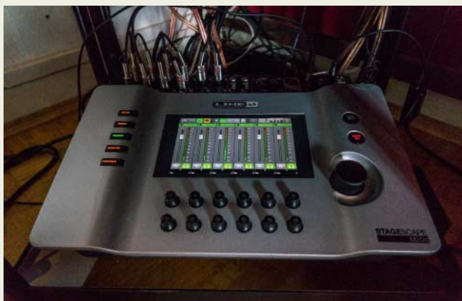
Über seinen Touchscreen stellt das Mischpult StageScape M20d von Line 6 die Pegel der einzelnen Kanäle dar.
