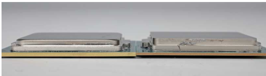
Intel verwendet bei Skylake-Prozessoren (rechts) eine nur noch 0,8 mm dicke Platine, die bei hohen Belastungen brechen kann. Der Unterschied zur Vorgängergeneration Haswell (1,1 mm) ist deutlich erkennbar.
