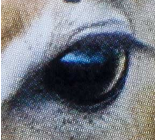
Unter der Lupe ist im Digitaldruck ein Druckraster erkennbar.
