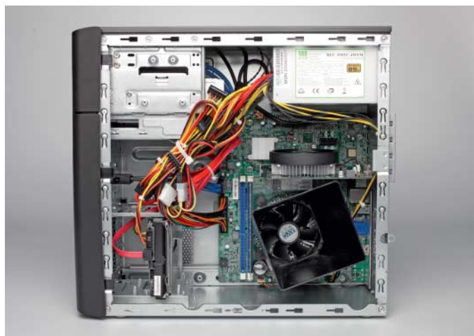
Im Aldi-PC Akoya P5320 E steckt ein mager ausgestattetes H110-Mainboard.
