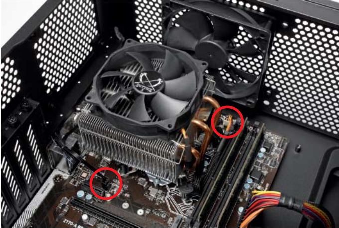
Kühlsystem 11-Watt-PC: Damit die Luft ungehindert durchs Gehäuse strömen kann, haben wir den Gehäuselüfter unter Dach gesetzt und den CPU-Kühler so montiert, dass seine Lamellen senkrecht stehen. Zudem müssen die Lüfter an den richtigen Anschlüssen CPUFAN1 und SYSFAN1 hängen.
