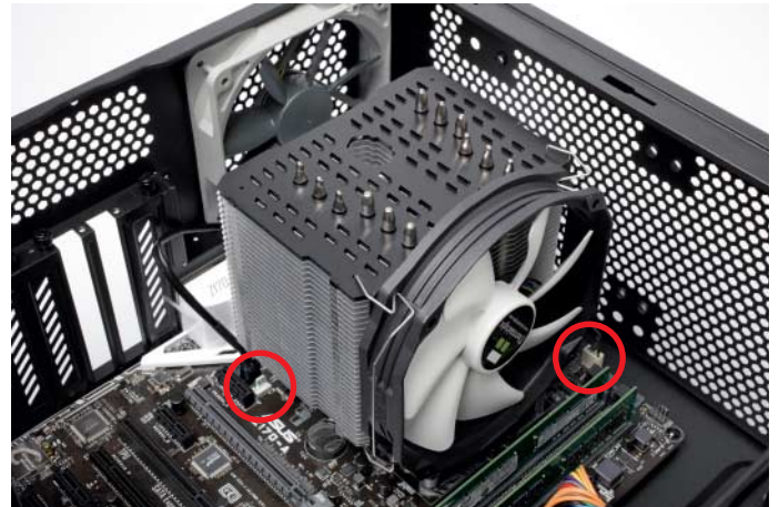
Kühlsystem All-inclusive-PC: Der 3-Pin-Lüfter vom Gehäuse musste einem PWM-Ventilator von Noctua weichen, der am mittleren Anschluss (CHA_FAN1) steckt. Der Lüfter des großen Tower-Kühlers (CPU_FAN) bläst nach hinten hinaus, da sonst die Grafikkarte (nicht abgebildet) den Ansaugweg blockiert.
