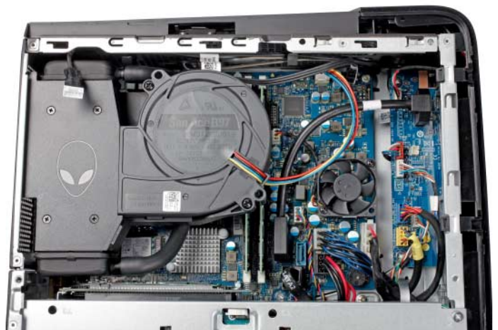
Oberhalb des Prozessors sitzt im Alienware X51 R3 ein mächtiger Radiallüfter, der den Wärmetauscher (links) der Wasserkühlung mit Luft versorgt.
