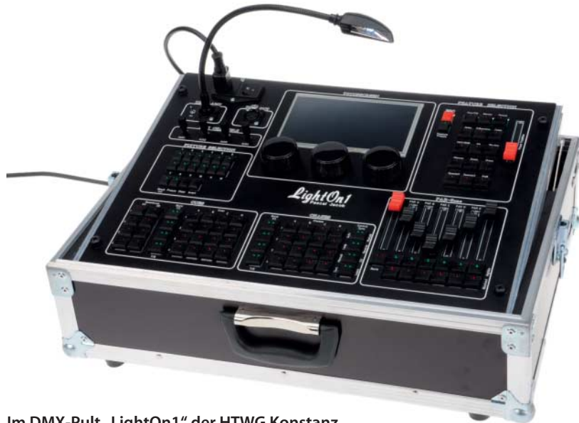
Im DMX-Pult „LightOn1“ der HTWG Konstanz stecken fünf Arduinos, 98 Taster, acht Fader und ein 7-Zoll-Touchscreen.
