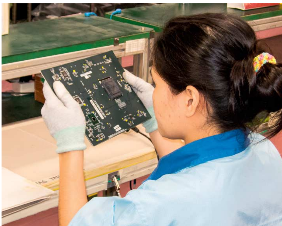
Falsch positionierte oder fehlende Bauteile fallen in der Zwischenkontrolle auf.
