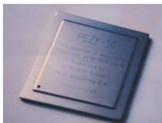
Der Pezy-SC mit 1024 Kernen, sein Nachfolger im 16-nm-TSMC-Prozess soll 4096 Kerne aufweisen.
