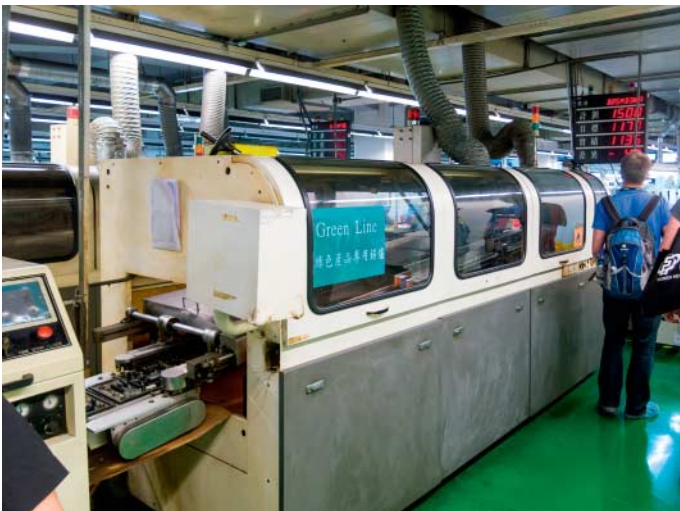
In den Reflow-Öfen gehen die Bauteile und die Platine eine dauerhafte Lötverbindung ein.
