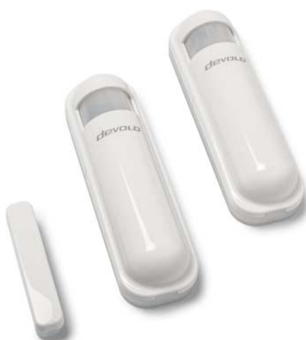
Der Tür/Fensterkontakt und der Bewegungsmelder überwachen auch die Temperatur im Raum und die Umgebungshelligkeit.
