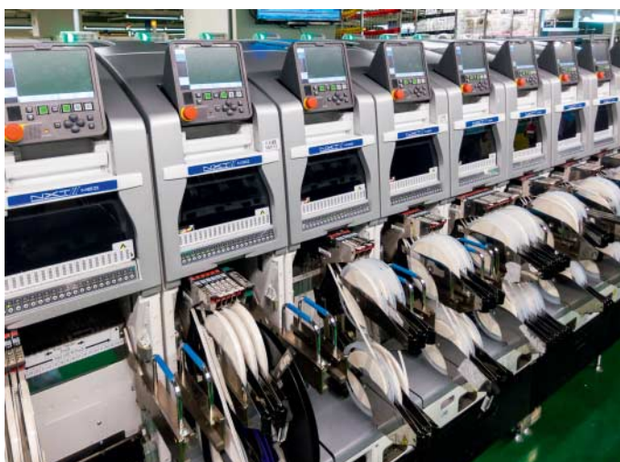
Die Platinen fahren von links nach rechts durch die Bestückungsautomaten. Auf jeder Rolle sitzen mehrere tausend Bauelemente.
