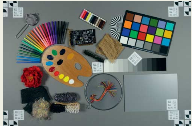
Die Testtafel deckt Rauschen, Farbfehler und Weichzeichner auf.
