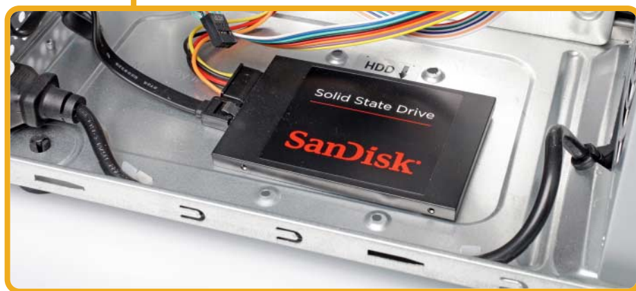
Weil das große Gehäuse keinen Einbauplatz für 2,5"-Laufwerke hat, schraubte Christian die SSD direkt auf die Bodenplatte und missbrauchte dazu eigentlich für Lüfter gedachte Bohrungen.
